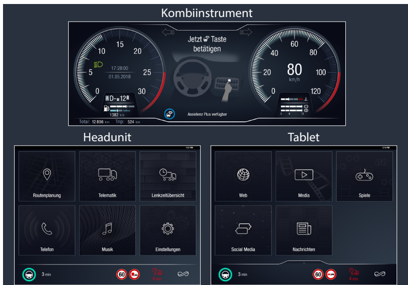
Kombiinstrument, Headunit und Tablet des automatisierten Lkws
