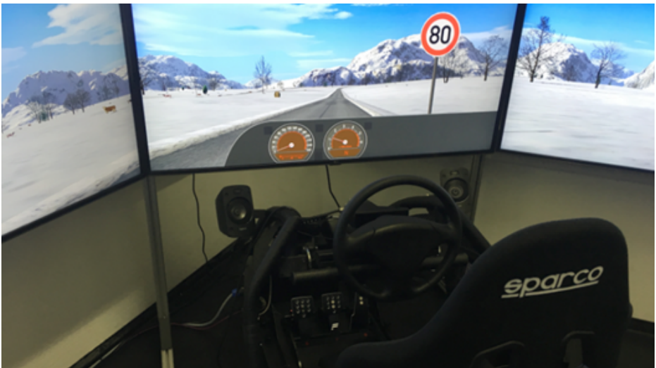
Aufbau des Fahrsimulators der Hochschule der Medien
