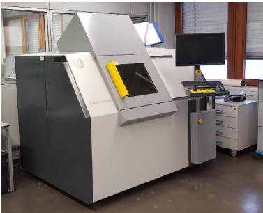
Bild 5.12: Röntgengerät "phoenix nanome|x"
