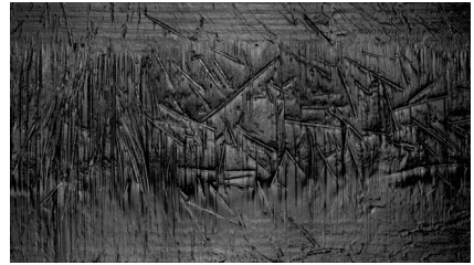
Bild 5.23: Schädigung Gegenlauffläche (oberer Lippendichtring)
