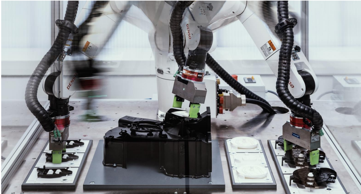
Abbildung 1.2: Kraftgeregelte Montage von Kunststoffbauteilen
