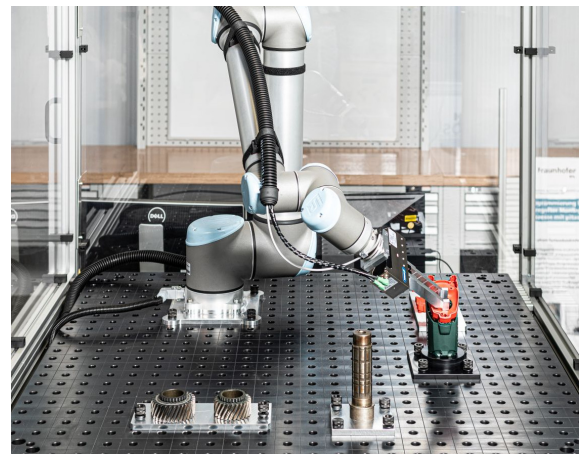
(d) Montage eines Gehäuseteils und Aufschieben eines Stirnrads (Universal Robots UR10)
