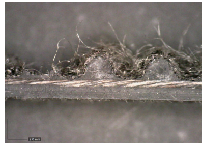
Bild 7.4: Ausgefallener Zahnriemen aufgrund von Zahnabscherung
