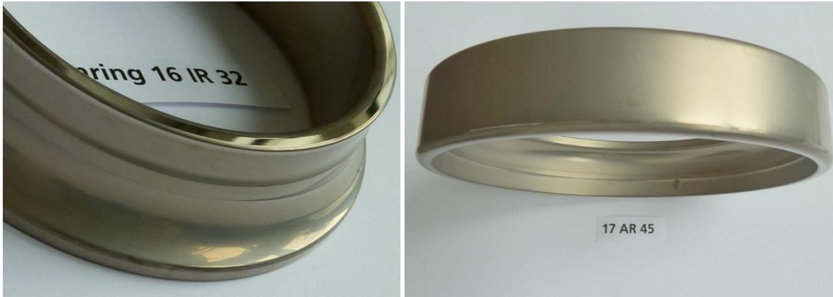
Abbildung 8.34: Makroansichten aus Versuchsreihe 2. Links ist die Lauffläche eines Innenrings dargestellt (V05, IR32), rechts der Blick auf Außendurchmesser und Lauffläche eines Außenrings (V06, AR45)
