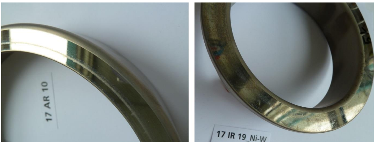
Abbildung 8.35: Kontaktflächen-Ansichten. Links AR 10 (V10) mit glänzender Kontaktfläche und relativ klar abgegrenzten Streifen, rechts IR 19 (V15) ohne Streifen, aber mit optischen Unregelmäßigkeiten.
