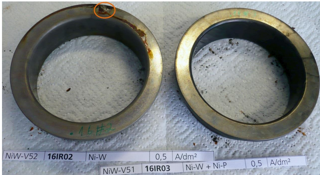
Abbildung 8.44: 0,5 A/dm 2 Nennstromdichte, Ansicht von oben. Links Einschichtsystem Nickel-Wolfram mit einem Korrosionspunkt in der Markierung an der Oberseite, rechts Kombinationsschicht NiP-NiW ohne Korrosionsstellen. Quelle: IPA intern bzw. (Kölle 2018)
