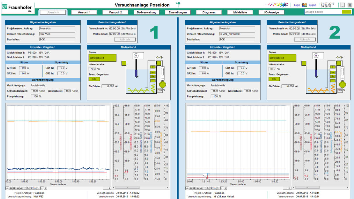
Abbildung 12.1: Anlagenübersicht der Benutzeroberfläche, die Istwerte beider Badstationen werden angezeigt.
