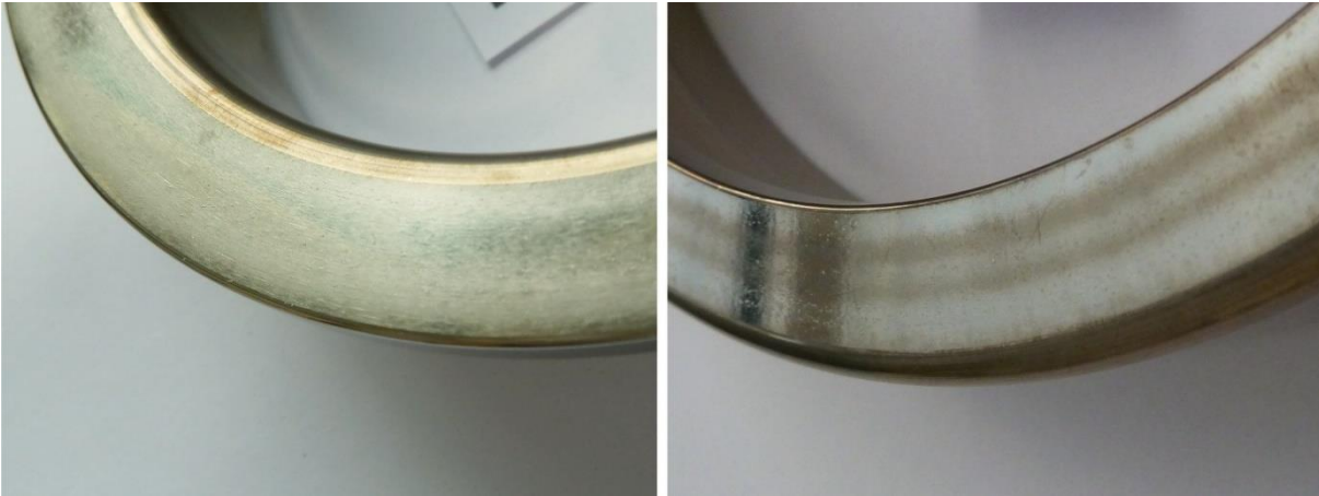
Abbildung 8.23: Kontaktflächen-Detailansichten des Innenrings 18 (EV01, links) und Außenrings 35 (EV02, rechts)
