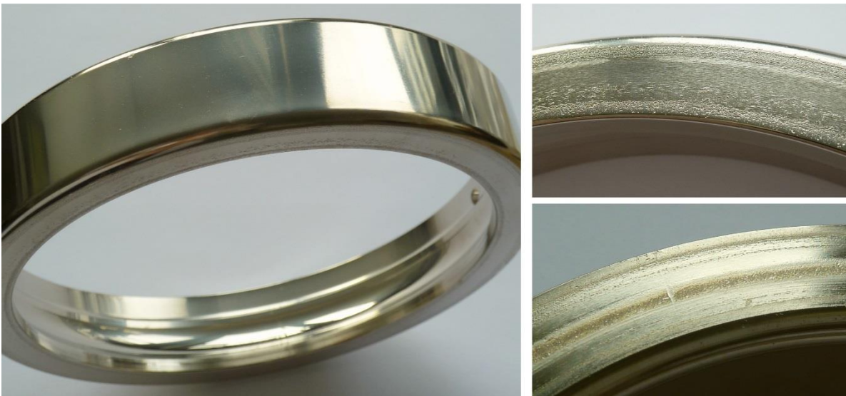
Abbildung 8.19: Makroaufnahmen der ersten Ringbeschichtungen. Links: Gesamtansicht des Außenrings AR55 aus EV01. Rechts: Detailaufnahmen der Kontaktfläche (oben: Außenring AR55, unten: Innenring IR1)
