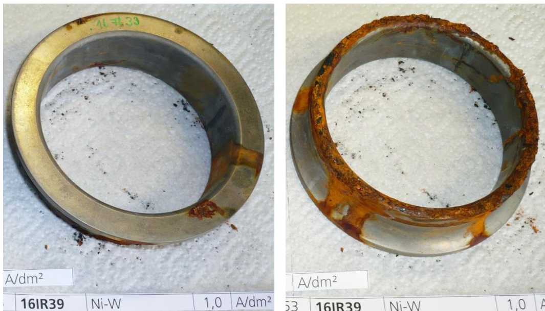
Abbildung 8.43: 1 \text{ A/dm}^2 Nennstromdichte, Ansicht von oben und unten (ungewaschen) . Links Oberseite mit einem Korrosionspunkt, rechts Unterseite mit diversen Angriffspunkten an schmaler Stirnseite. Quelle: IPA intern bzw. (Kölle 2018)
