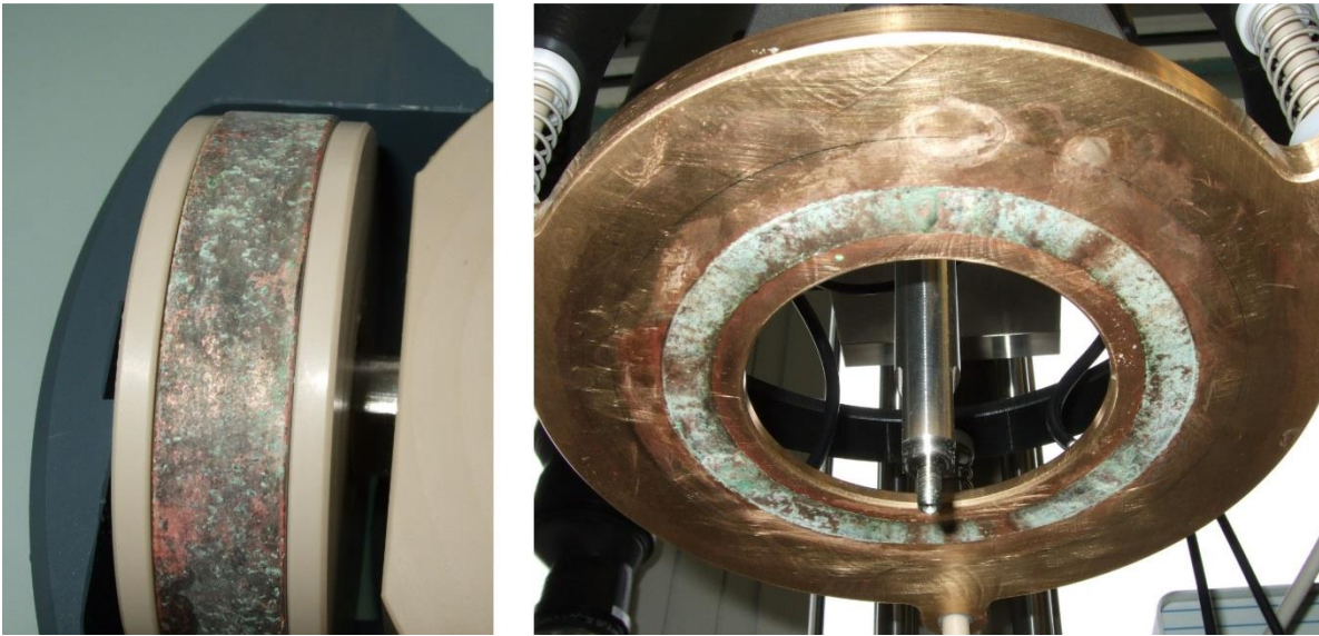
Abbildung 8.20: Kontaktrolle und Kontaktscheibe nach EV02 (IR25) mit 6 U/min. Erkennbar sind die Ablagerungen und Anbrennungen, welche eine Stromübertragung behindern bzw. verhindern.
