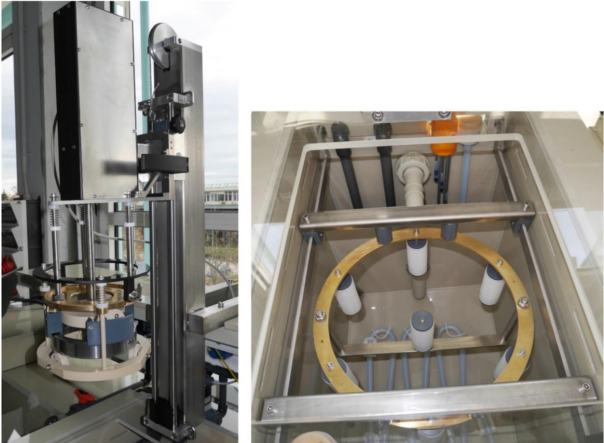
Abbildung 8.17: Horizontalvorrichtung (links), Anodensystem mit Behälter (rechts); jeweils vor den ersten Beschichtungen bzw. dem Befüllen der Anlage
