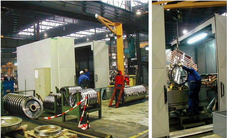
Abbildung 3.4: Beispiel einer Magnetpulverprüfanlage für Monoblockräder und Radreifen sowie -scheiben. (Deutsch et al. 2013)
