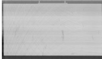
(b) Abgerolltes Wärmebild bei 150 kHz und 20% der Leistung des Induktionsgenerators (max. 20 kW)
