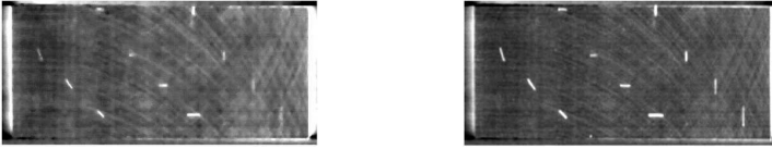
Abbildung 4.16: Anwendung eines Median- (links) und Gaussfilters (rechts) mit einem 5x5-Kernel auf eine Wärmebildaufnahme des Testkörpers
