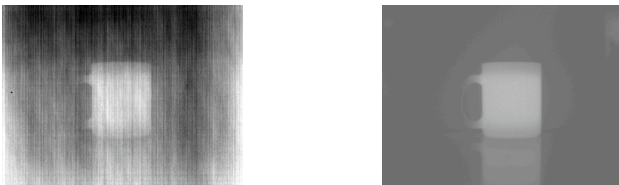
Abbildung 4.13: Vergleich einer Wärmebildaufnahme vor (links) und nach (rechts) einer Nonuniformity Correction
