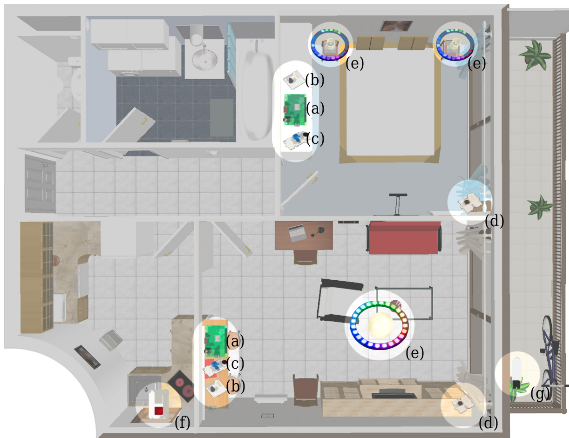
Abbildung 4.1: Aufbau des Smart-Homes bestehend aus zwei Raspberry Pis [Fou](a), zwei Temperatursensoren [Lin16c](b), zwei Geräuschsensoren [Lin16b](c), zwei Lichtsensoren [Lin16a](d), ambienter Beleuchtung [Ind](e), einem Bosch XDK [Bos](f) und einem Pflanzensensor [Xia]. Architekturmodell aus SweetHome3D[Puy]
