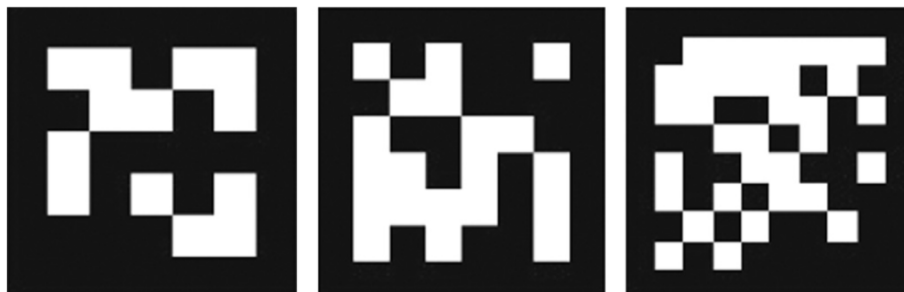
Abbildung 2.3: Unterschiedlich große Marker; von links nach rechts n=5 , n=6 , n=8 [GMMM14]
