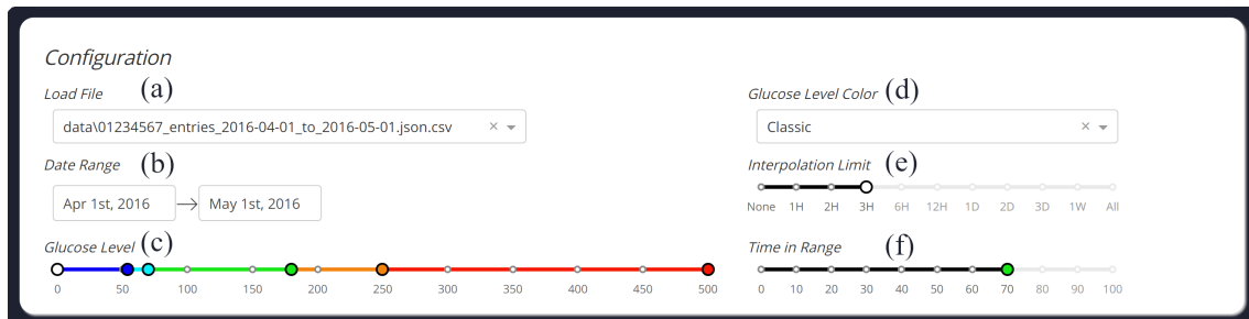
Abbildung 4.9: Konfigurationsbereich des Visualisierungssystems: (a) Datei laden; (b) Datumsfenster; (c) Wertebereich der Glukosebereiche; (d) Farben der Glukosebereiche; (e) Interpolationsgrenze; (f) Zielwert für den Zielbereich (TIR).
