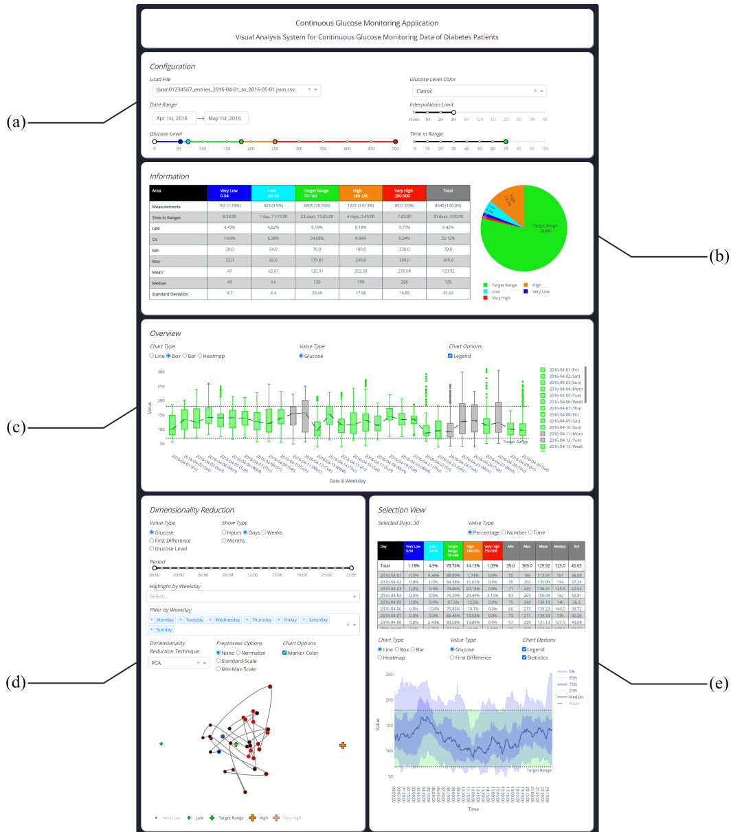
Abbildung 4.8: Grafische Benutzeroberfläche des Visualisierungssystems: (a) Konfigurationsbereich; (b) Informationsbereich; (c) Übersichtsreich; (d) Dimensionsreduktionsbereich; (e) Selektionsbereich.
