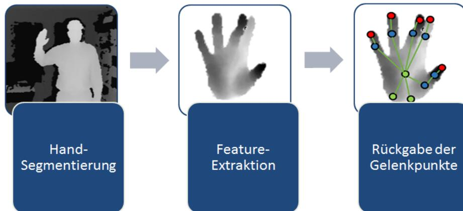
**Abbildung 3.1:** Generelle Funktionsweise der Handkennungsalgorithmen. In dem ersten Schritt erfolgt die Segmentierung der Hand, im zweiten Schritt die Extraktion der Merkmale. Am Ende werden anhand der extrahierten Merkmale die 3D-Positionen der Gelenkpunkte abgeleitet. [NWNT17; pra].
