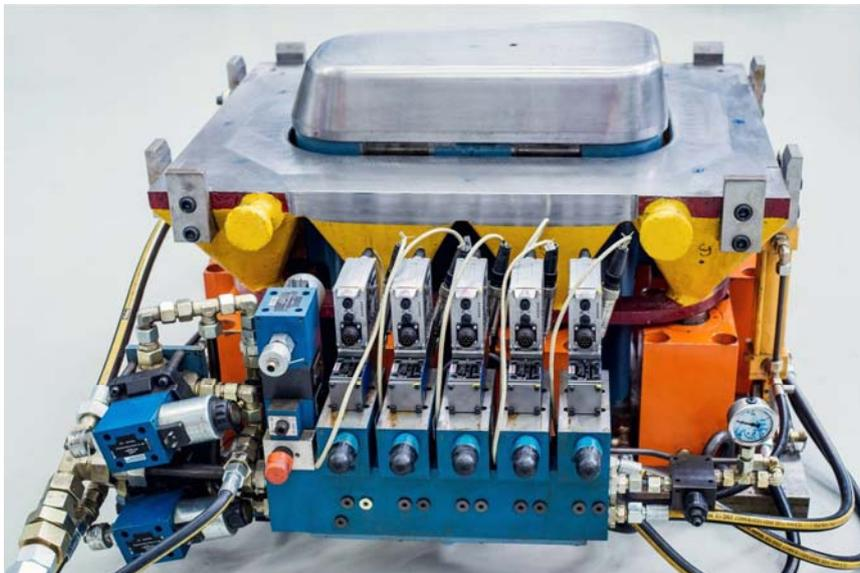
Abbildung 33: Verwendetes Werkzeug mit der KVG-Geometrie ohne Matrize, welches mechanisch von [Häu02] entwickelt wurde und für diese Arbeit bzgl. der Elektronik umgebaut wurde.
