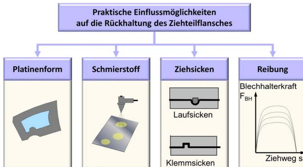
Abbildung 7: Möglichkeiten zur Beeinflussung des Rückhaltesystems beim Tiefziehen [Sie15].
