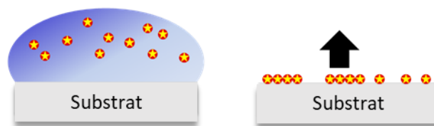
Abbildung 208: Schema der Trocknung der nicht deckenden Ionenschichten.
