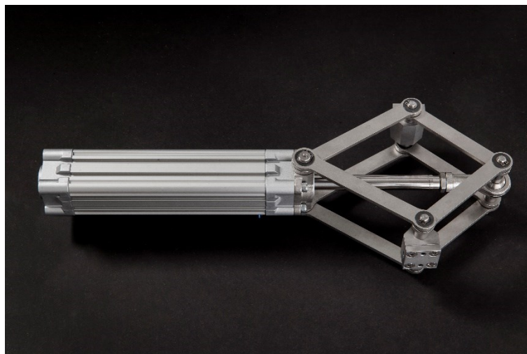
Abbildung 67: Pneumatischer Zylinder modifiziert mit Scheren © ILEK, Fotografin: Gabrielle Metzger
