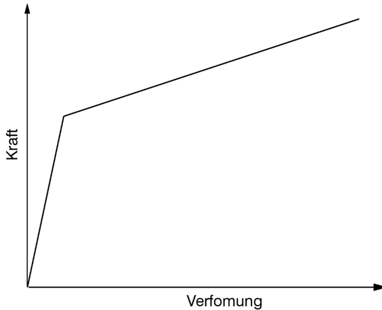
Diagramm 10: Schematische Darstellung des Kraft-Verformungs-Diagramms der bilinearen Feder-elemente der oberen Auflager des FE-Modells der Seilfassaden
