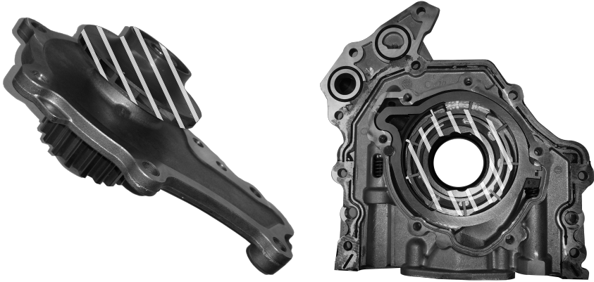
Abbildung 4.1: Modifikationen an Wasser- (links) und Ölpumpe (rechts). Die Schraffur markiert die jeweils entfernten Komponenten.
