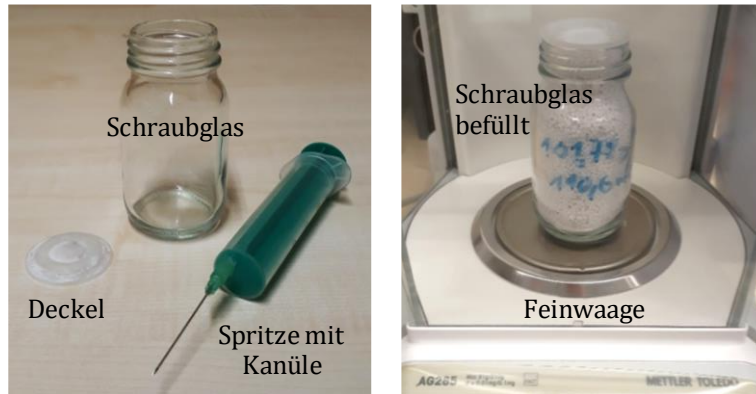
Abbildung 6-1: Messequipment für die Messung von mittlerer Korndichte und Reindichte von expandierten Perliten
