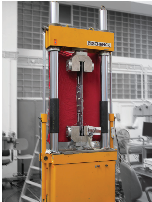
Abb. 9.2: Versuchseinrichtung für Schubbeanspruchung mit eingebautem Prüfkörper
