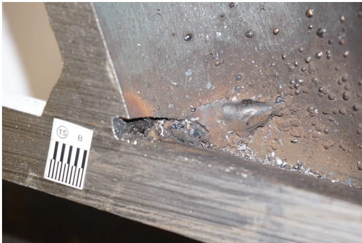
Abb. 5.5: Blick auf die Schweißnahtwurzel des Prüfkörpers Nr. 15
