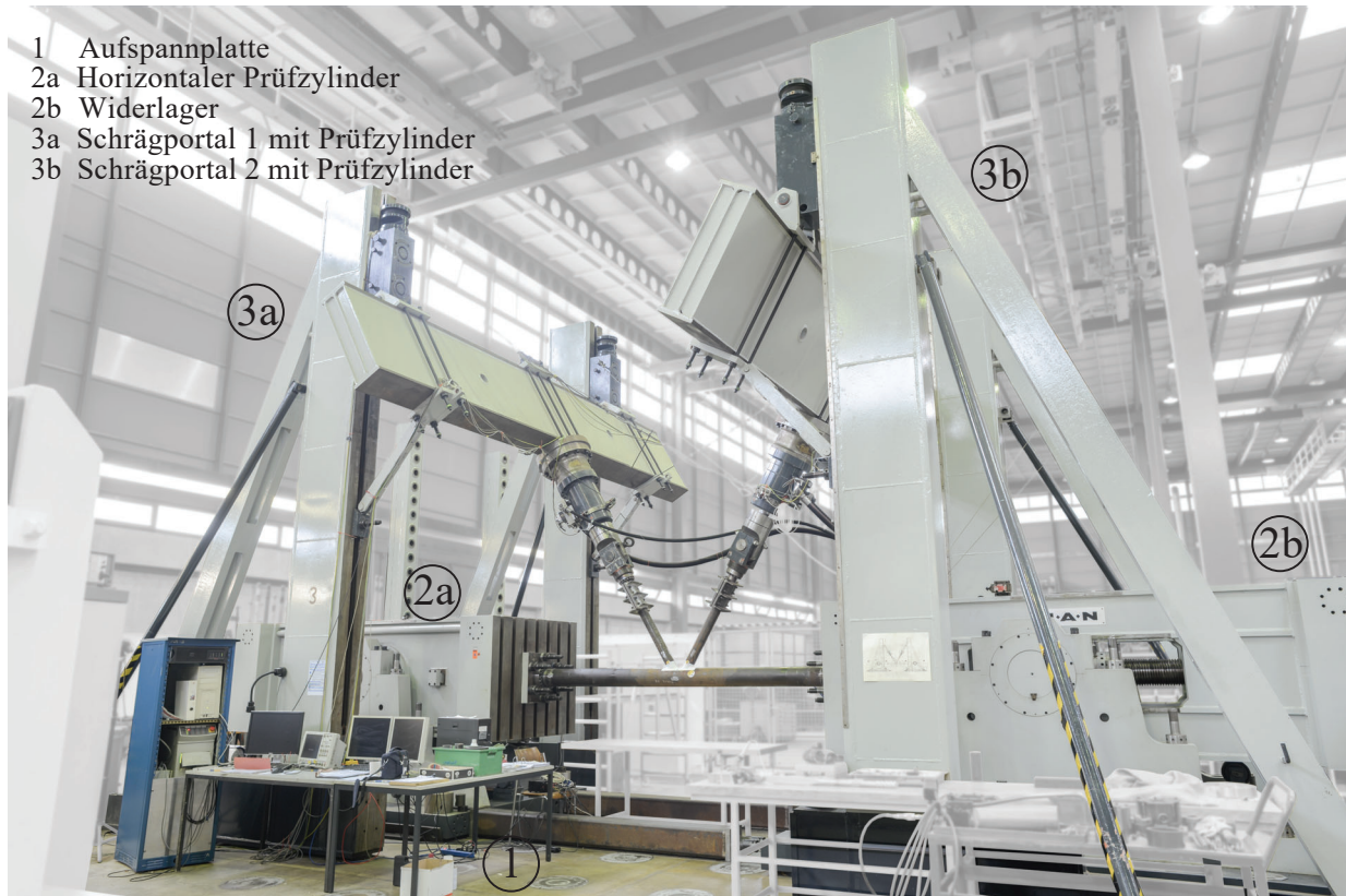
Abb. 5.6: Versuchsstand der Materialprüfungsanstalt (MPA) der Universität Stuttgart zur Untersuchung von K-Knoten mit Strebennormalkraft
