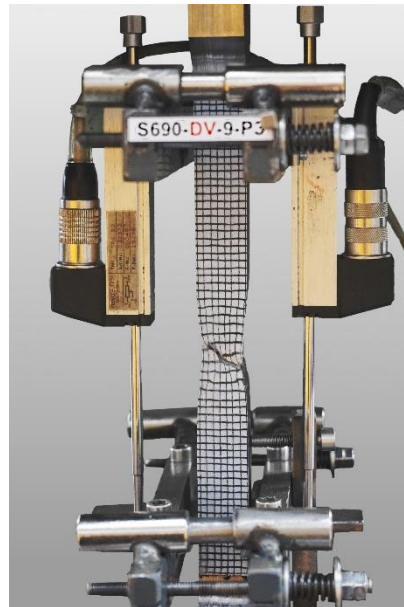
Abb. 8-9: Messsystem zur Dokumentation der lokalen Verformung des Versuchskörpers
