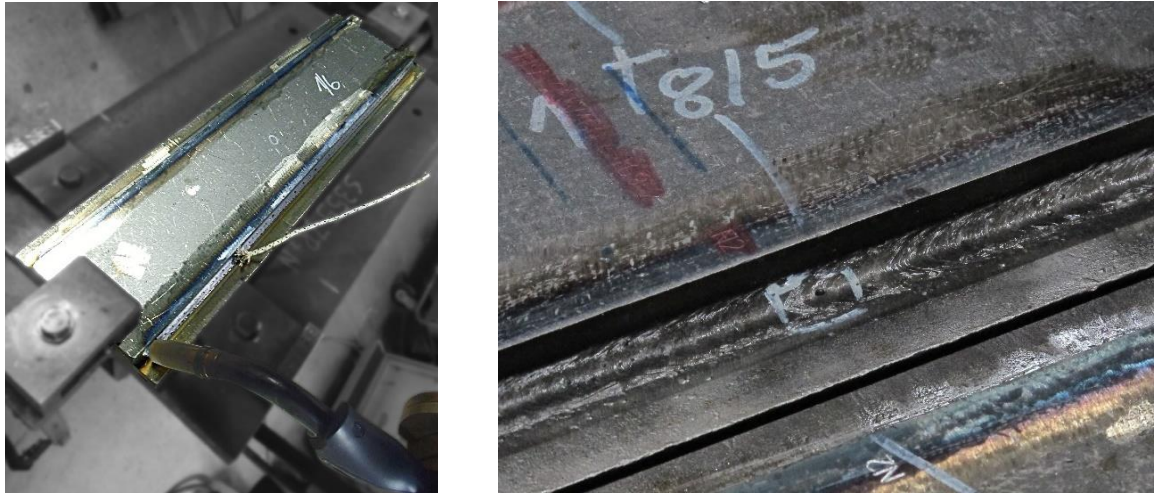
Abb. 6-6: Messung der t_{8/5} - Zeit mittels Thermoelement
