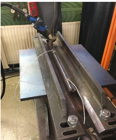
Abb. 8-6: Messung der Abkühlzeit mittels eingebrachter Thermoelemente
