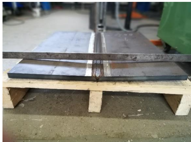
Abb. 8-7: Winkelverzug der ersten Probeschweißung
