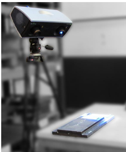
Abb. 6-12: Scannen der Bruchfläche mittels eines Streifenlichtprojektors Comet L3D [56]
