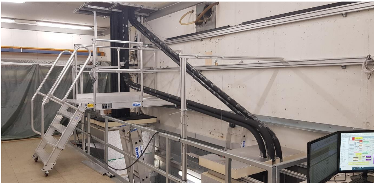
Abbildung 4.40: Foto vom ATHOS-Versuchsstand mit den zwei Wassertanks und Rohrbündeln
