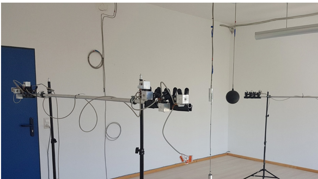
Abb. 19 Anordnung der 16 IR-Sensoren in Laborraum T3
