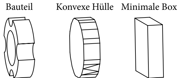
Abbildung 2.45: Bauteil, konvexe Hülle und Minimale Box
