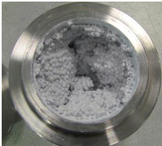
Abbildung 67: Mahlbecher mit Probe: 50 ml Edelstahlbecher mit 2 mm Edelstahlkugeln und NTO sowie Ethanol als Dispersionsmedium nach kurzem Mahlen.
