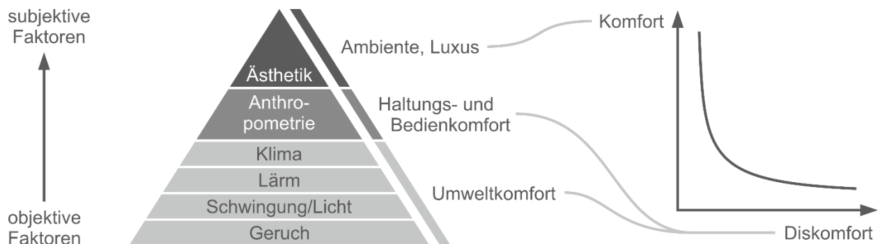
Bild 2.16: Komfortmodell basierend auf [BUBB 2003], [KRIST 1994], [BUBB 1995], [WAWZYNIAK 2016, S. 701] und [ZHANG ET AL. 1996]
