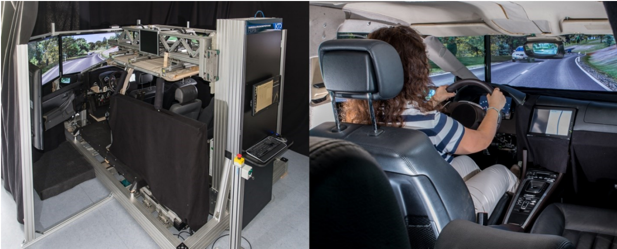
Bild 2.8: Fahrzeug-Ergonomie-Prüfstand des IKTD
