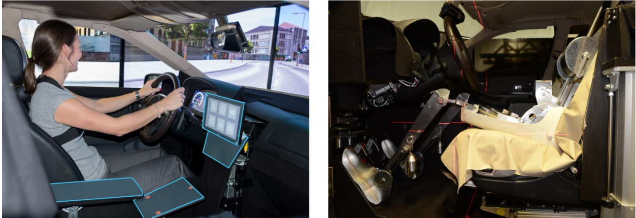
Bild 5.6: Verstellbare Mittelkonsole (links) und H-Punkt-Messmaschine (rechts)
