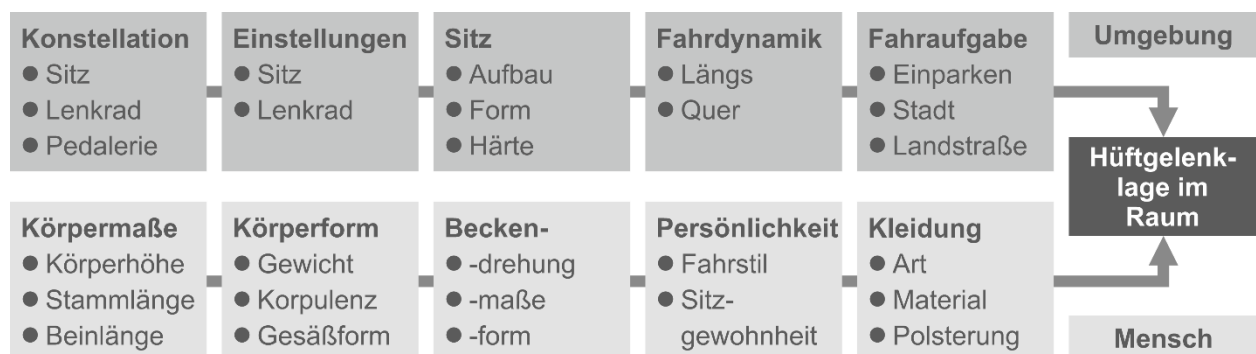
Bild 2.9: Einflussfaktoren auf die Hüftgelenklage basierend auf [KOLLING 1997, S. 41]
