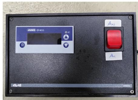
**Abb. 5.5:** Netzteil zur Stromversorgung in Verbindung mit einer Temperaturregelungseinheit zur Ansteuerung der Heizpatrone
