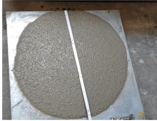
**Abb. 5.17:** Bestimmung des Ausbreitmaßes (im vorliegenden Fall 630 mm) während der Betonage der adaptiven Biegeträger
