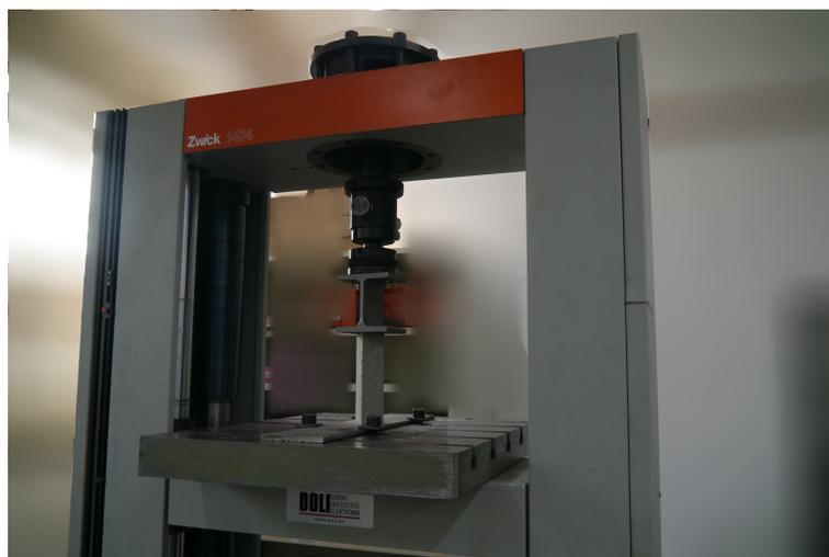
**Abb. C.1:** Prüfaufbau mit Betonprobe zur Bestimmung des E-Moduls
