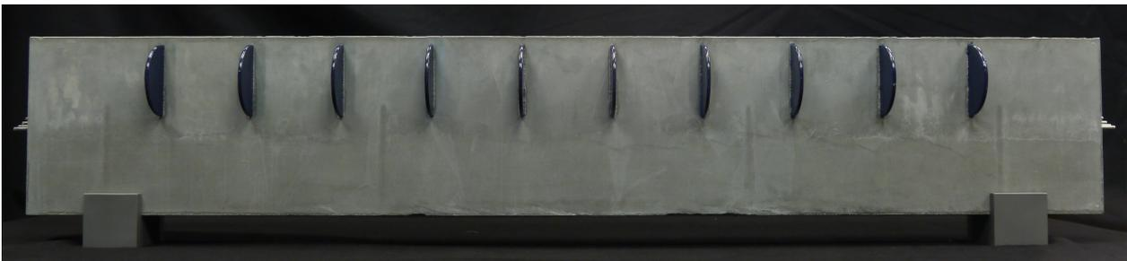
**Abb. 5.16:** Als Funktionsmuster nur bis zur senkrechten Mittelebene betonierter Biegeträger mit 10 integrierten Aktoren
