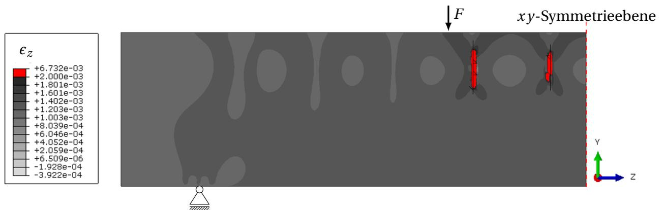
Abb. 4.30: Dehnungen in Trägerlängsrichtung  $\epsilon_z$
