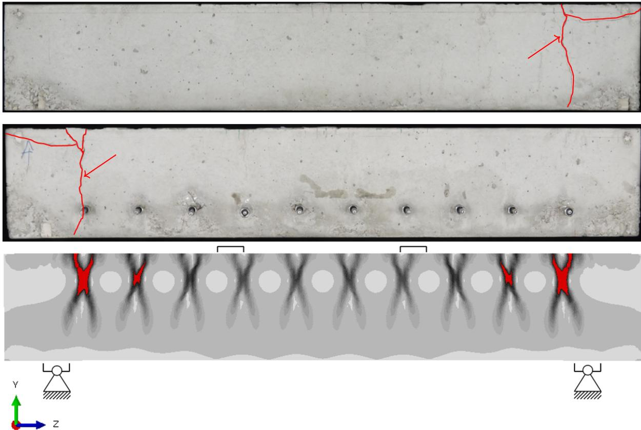
**Abb. 6.32:** Vorhersage der Rissposition über die FEM-Simulation möglich. Gute Übereinstimmung des Rissbildes aus dem Versuch: Rück- (oben) und Vorderseite (Mitte) des Biegeträgers U1 nach Versuchsende mit deutlichen Rissen am äußeren Aktor 1 und das Rissbild aus der FEM (unten) (in Rot: Bereiche mit Grenzdehnung  $\epsilon_z \geq 2 \text{ ‰}$ )
