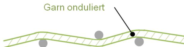
Abbildung 14: Schematische Darstellung eines ondulierten Garns und einer zweiten Garnlage
