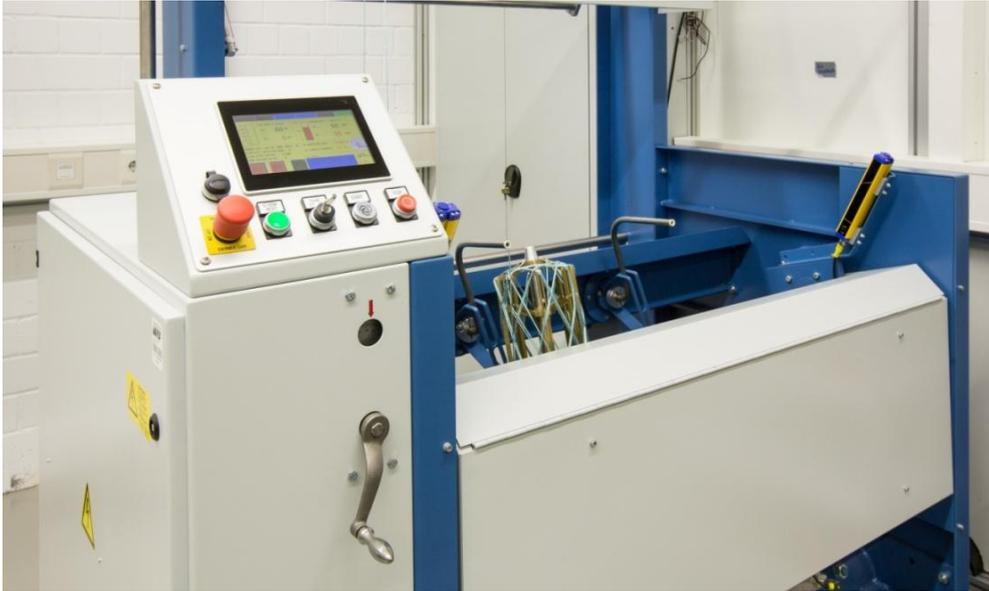
**Abbildung 37: Verwendete Strukturknäuelmaschine SBW 2 der JBF Maschinen GmbH**
