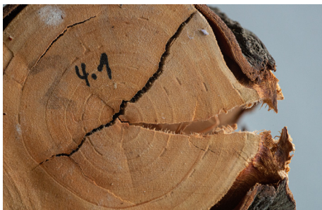
Weißdorn-Stamm ( Crataegus laevigata ) nach mechanischem Belastungsversuch. Steigende Druckbelastung bis zum Bruch des Holzes ergab Daten für den „Stuttgarter Festigkeitskatalog“ (gemeinsames Projekt der Technischen Biologie [U. Kull] und Ingenieurwissenschaften [Bau- und Modellstatik] der Universität Stuttgart; 1995). (Botanische Sammlung)
