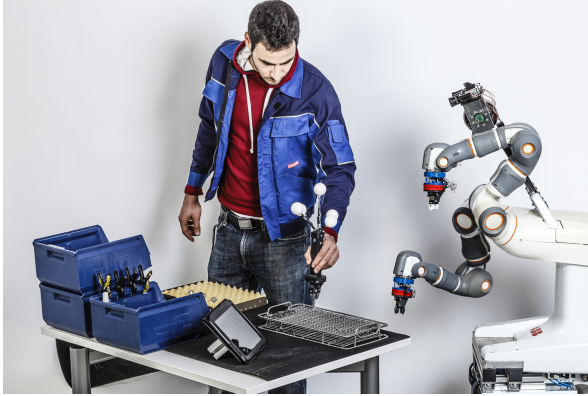
Abbildung 1.4: Programmierung einer Handhabungsaufgabe durch Demonstration des Bedieners. Durch eine Tiefenbildkamera werden die Positionen des handgeführten Greifers aufgezeichnet und in entsprechende Roboterarmbewegungen umgerechnet.
