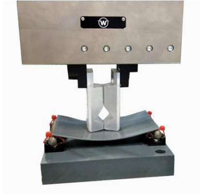
Abbildung 4.5: Mechanischer Aufbau zur Untersuchung verschiedener Umgebungssteifigkeiten
