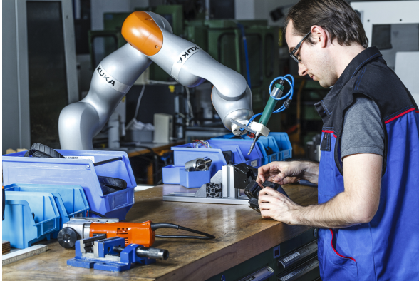
Abbildung 1.1: Der Leichtbauroboter IIWA der Firma KUKA im kollaborativen Betrieb zur Unterstützung von Montagefähigkeiten
