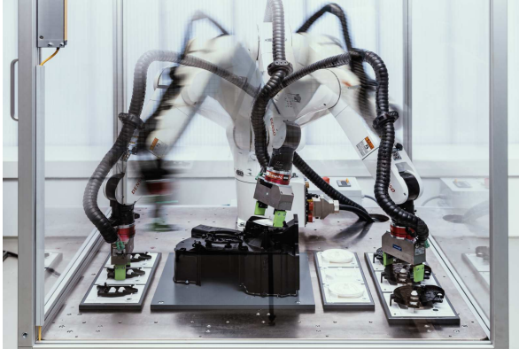
Abbildung 1.6: Fotomontage der verschiedenen Teilabläufe einer kraftgeregelten Montage von Kunststoffteilen zur robusten Produktion trotz Bauteiltoleranzen
