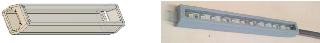
Abbildung 3.7: Technische Zeichnung einer additiv gefertigten Halteschiene für LEDs (links) sowie Platzierung einer LED-Leiste in der Halteschiene (rechts).
