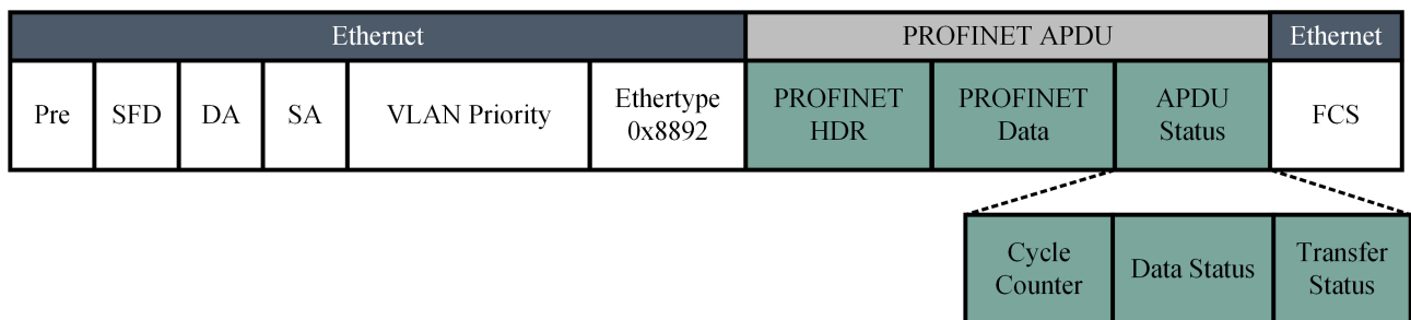
Abbildung 6.12: Struktur eines PROFINET-Frames.
