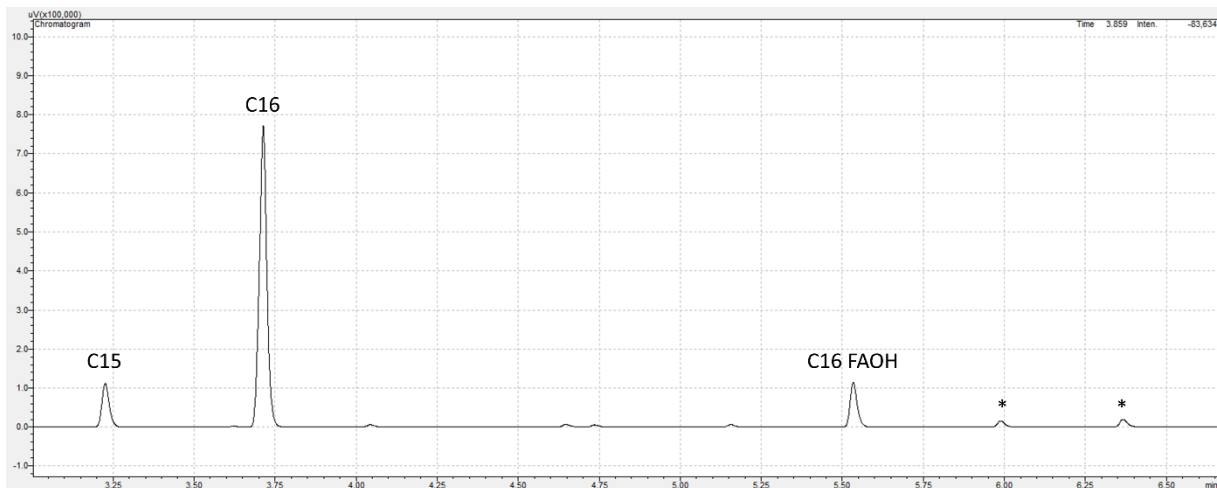
Abbildung 57: GC-Chromatogramm für die CYP153A M.aq (Variante M.aqR) katalysierte Reaktion mit Hexadecansäure (C16). Mit dem Produkt \omega -Hydroxyhexadecansäure (C16 FAOH) und dem internen Standard Pentadecansäure (C15). Unreinheiten sind durch Sterne (*) markiert.
