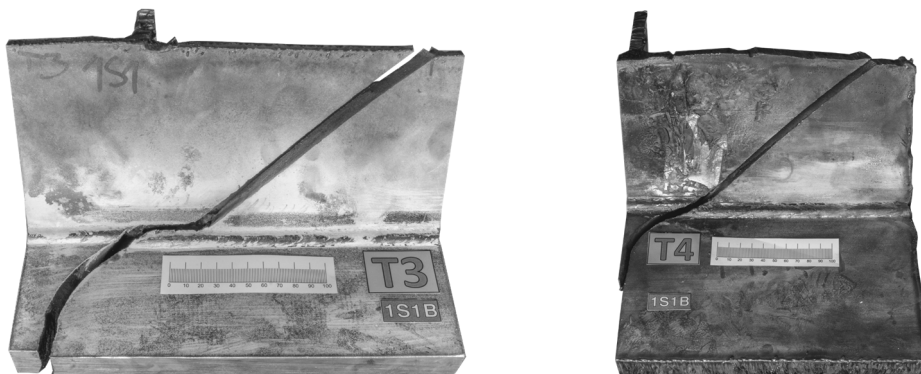
Bild 11-37: Bruchbild des Trogbrückenversuchs T3 an der Stelle 1S1B und des Trogbrückenversuchs T4 an der Stelle 1S1B
