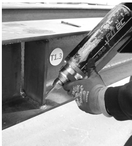
Bild 5-6: Nachbehandlung mit PIT durch die Firma Pitec GmbH (links) herkömmlich mit rundem Pin, rechts) konkave Pinform für Nachbehandlung entlang äußerer Kanten
