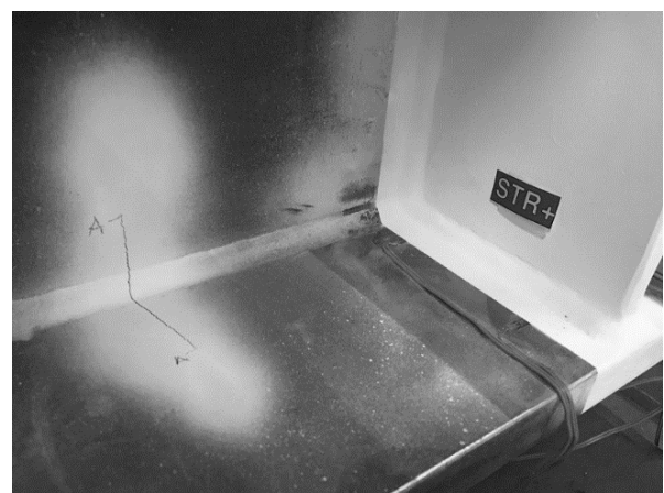
Bild 11-42: Versagen eines geschweiten Tragers quer uber die Doppelkehlnaht der Halsnaht am biegezugbeanspruchten Untergurt aus dem Forschungsprojekt OptiBri [74]
