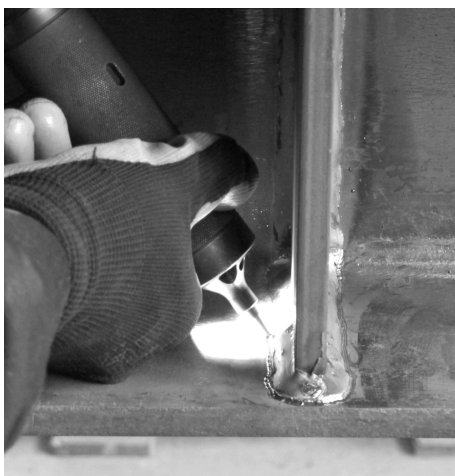
Bild 5-5: Nachbehandlung mit HiFIT durch die Firma DYNATEC GmbH
