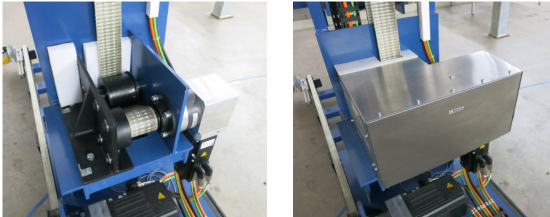
Abbildung 8.10: Einhausung des Riementriebs an der Hubachse. Quelle: Eigene Darstellung.
