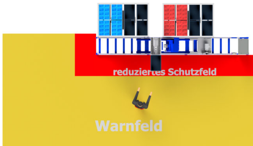
Abbildung 9.7: Reduziertes Schutzfeld am Beginn des Andienungsprozesses, x- und y-Achse im SOS-Zustand, z-Achse aktiv.
