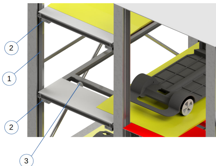
Abbildung 5.38: Detailansicht Zahnstangenantriebe des Dynamischen Lagers. Pos.1: Zahnstange an der Tragstruktur für Lagerbodenvertikaltrieb. Pos.2: Antrieb des Lagerbodenvertikaltriebs. Pos.3: Antrieb zur Querverschiebung des Lagerbodens.
