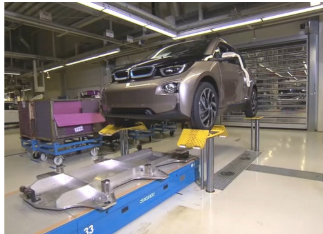
Abbildung 2.15: Verladen und auf den Boden Absetzen eines fertig montierten BMW i3 mithilfe einer Säulenhubarbeitsbühne.
