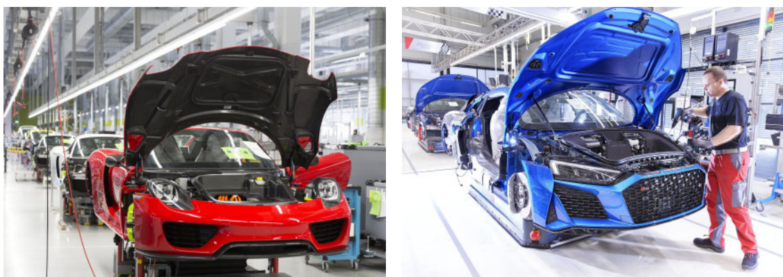
Abbildung 2.11: Linienförmige Förderung der Werkstücke auf monofunktionalen FTF in den Endmontagen des Porsche 918 Spyder und des Audi R8. Quelle: Dr. Ing. h.c. F. Porsche AG, Audi AG.
