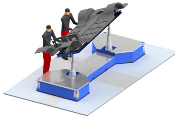
Abbildung 4.4: Im Aufbau befindlicher PKW auf der Mobilen Montageinsel. Quelle: Eigene Darstellung.
