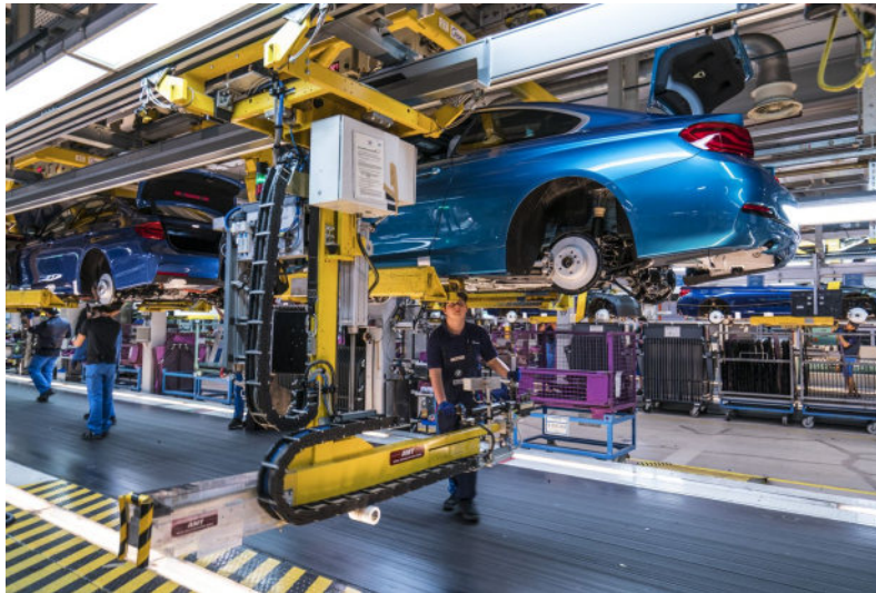
Abbildung 2.5: Elektrohängbahn mit darunter befindlichem Bandförderer als Standfläche des Montagepersonals. Quelle: BMW AG.
