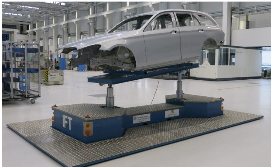
Abbildung 5.12: Neigen des Werkstückträgers um dessen Querachse. Quelle: Eigene Darstellung.
