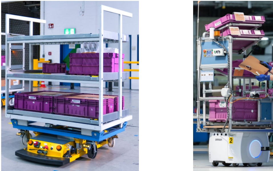
Abbildung 2.23: FTF zum Transport von Regalmodulen. Quelle: BMW AG.
