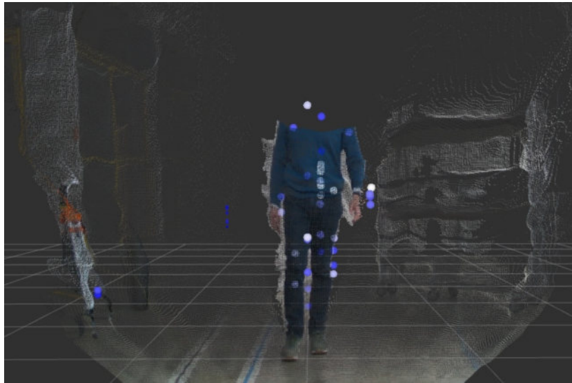
Abbildung 9.16: Klassifizierung und Identifikation einer Person anhand spezifischer Merkmale (Extremitäten) mittels bildverarbeitender Sensorik und eines Radarsensors. Quelle: Korte 2021 [Kor21].
