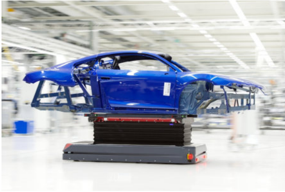
Abbildung 5.1: Monofunktionales Transport-FTF mit Hubfunktion in der Produktion des Audi R8. Quelle: BÄR Automation GmbH.
