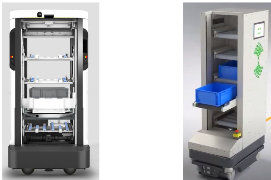
Abbildung 2.25: FTF mit Ladungsträger als Einheit und integrierter Handhabungstechnik. Quellen: Magazino GmbH, TruPhysics GmbH.
