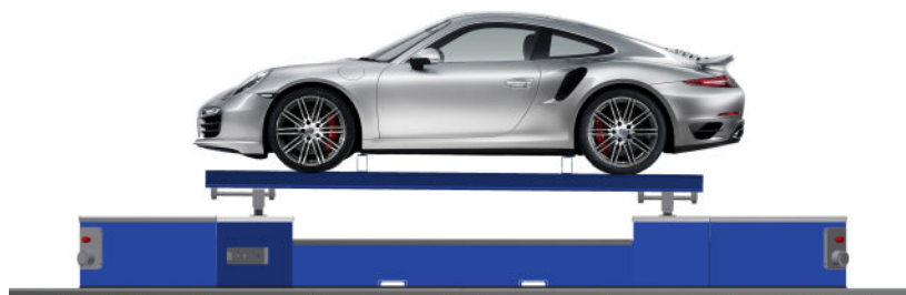
Abbildung 4.5: Fertig montierter PKW auf der Mobilen Montageinsel. Quelle: Eigene Darstellung mit Inhalten der Dr. Ing. h.c. F. Porsche AG.
