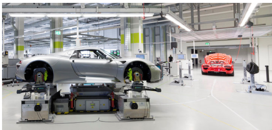
Abbildung 2.16: Absetzen fertig montierter Porsche 918 Spyder vom FTF auf den Boden im end-of-line-Bereich.
