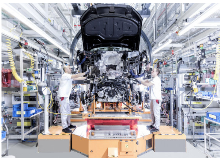
Abbildung 2.19: Materialbereitstellung aus Regalsystemen zu beiden Seiten der Montagelinie. Quellen: Audi AG.
