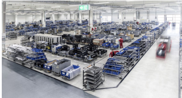
Abbildung 2.20: Logistiksupermarkt für den Warenumschlag, die Kommissionierung und Beschickung von Transporteinheiten zum Verbauort. Quelle: Audi AG.
