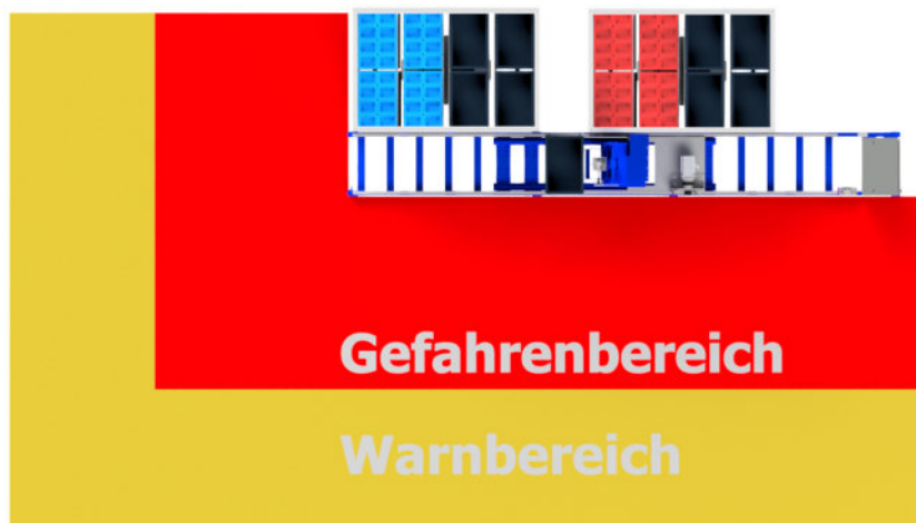
Abbildung 9.6: Schutzfeld / Gefahrenbereich am Mini-RBG während des Betriebs aller 3 Achsen. Rot dargestellt: Schutzfeld der Laserscanner/Gefahrenbereich Gelb dargestellt: Warnfeld der Laserscanner
