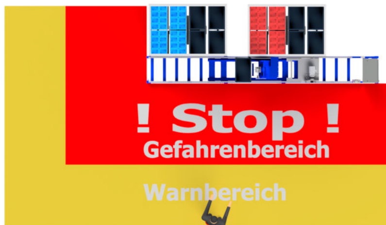
Abbildung 9.19: Zielgerichtete Signalisierung des Gefahrenbereichs (rot) und Information, diesen nicht zu betreten, bei Eintritt in den Warnbereich (gelb).
