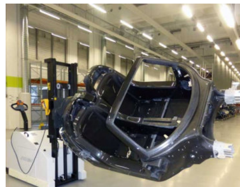
Abbildung 5.4: Mobiler manuell geführter Werkstückmanipulator auf Basis eines Elektrohubgabelwagens für die Produktion des Porsche 918 Spyder. Quelle: IMS Handhabungstechnik GmbH.
