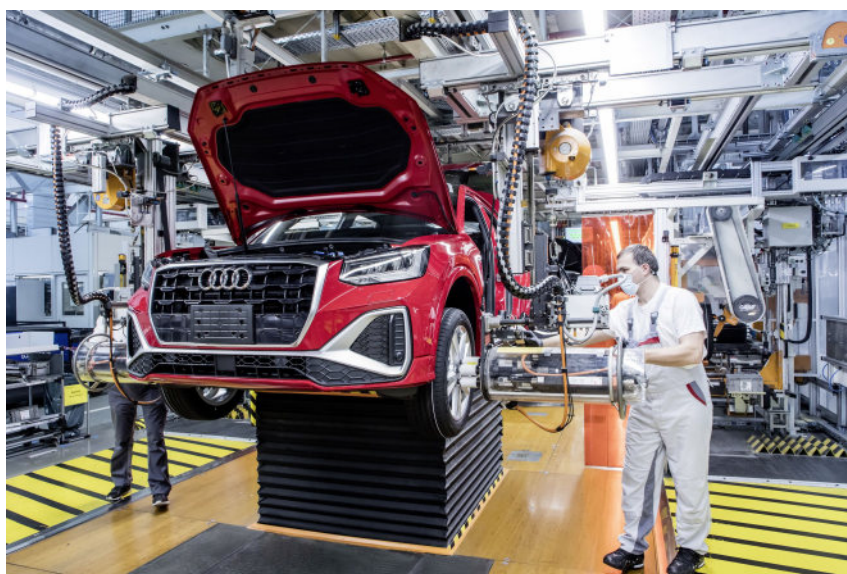
Abbildung 2.10: Schubplattformförderer mit Stehplattform in Holzbodenausführung. Quelle: Audi AG.
