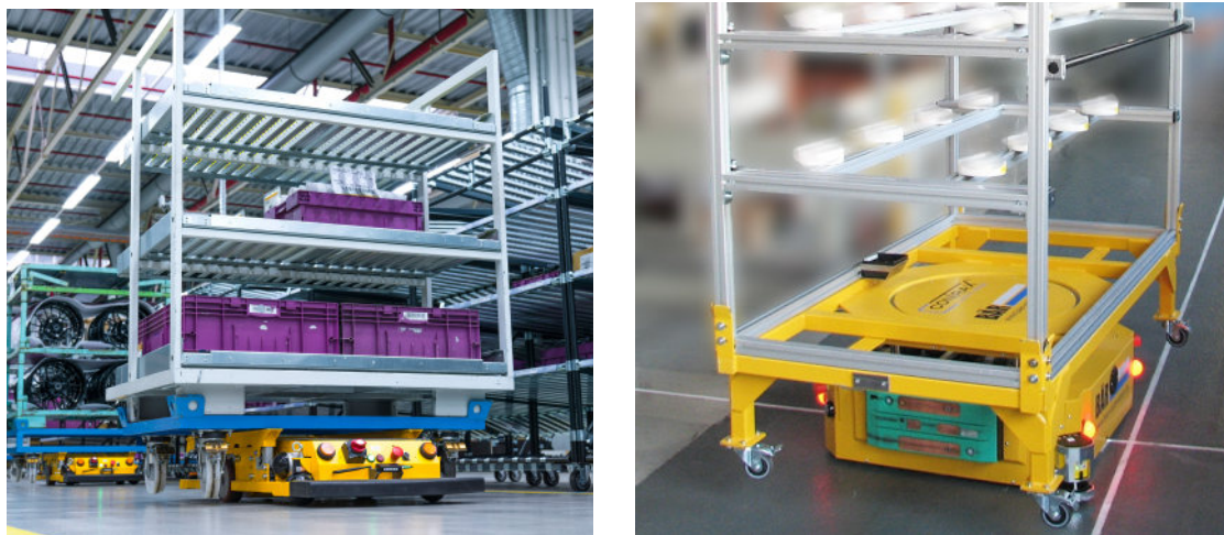
Abbildung 2.24: Regaltransport im angehobenen Zustand. Quellen: BMW AG, Bär Automation GmbH.
