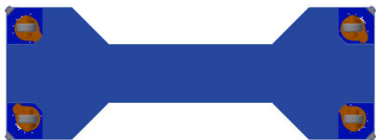
Abbildung 5.6: Positionierung der 4 Schwenkantriebe im Chassis der Mobilen Montageinsel – Ansicht von unten. Quelle: Eigene Darstellung.
