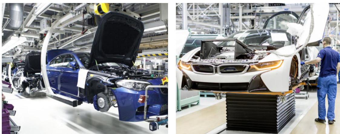
Abbildung 2.1: Elektrohängebahn (links) und Schubplattform mit Hubeinrichtung (rechts) am Beispiel der Endmontage von BMW.
