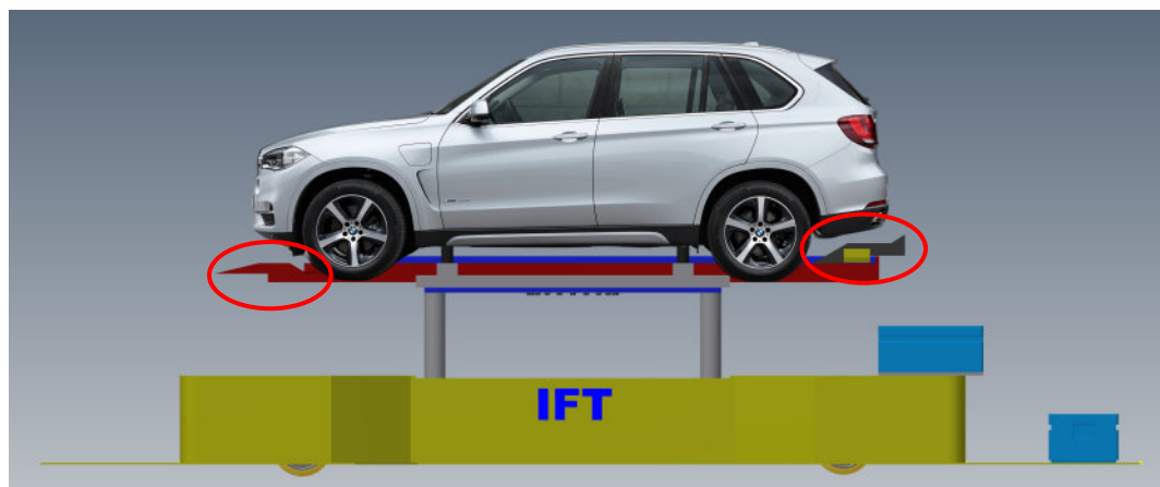
Abbildung 5.22: Fertig montierter PKW auf der Mobilten Montageinsel.
