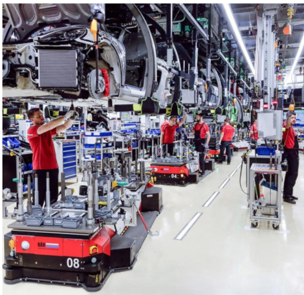
Abbildung 2.18: Hochzeit in der Produktion des Porsche Taycan mittels FTF und EHB. Quelle: Dr. Ing. h.c. F. Porsche AG.
