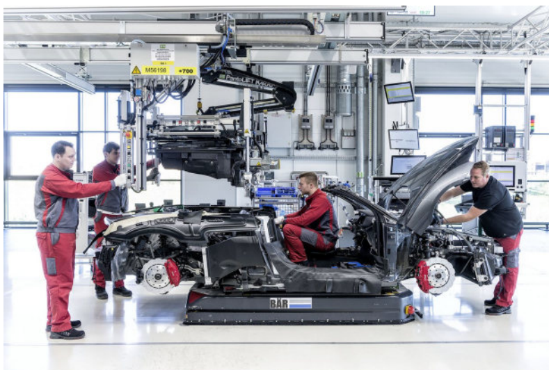
Abbildung 2.12: Monofunktionales FTF als Werkstückträger in der Fertigung des Audi R8. Quelle: Audi AG.
