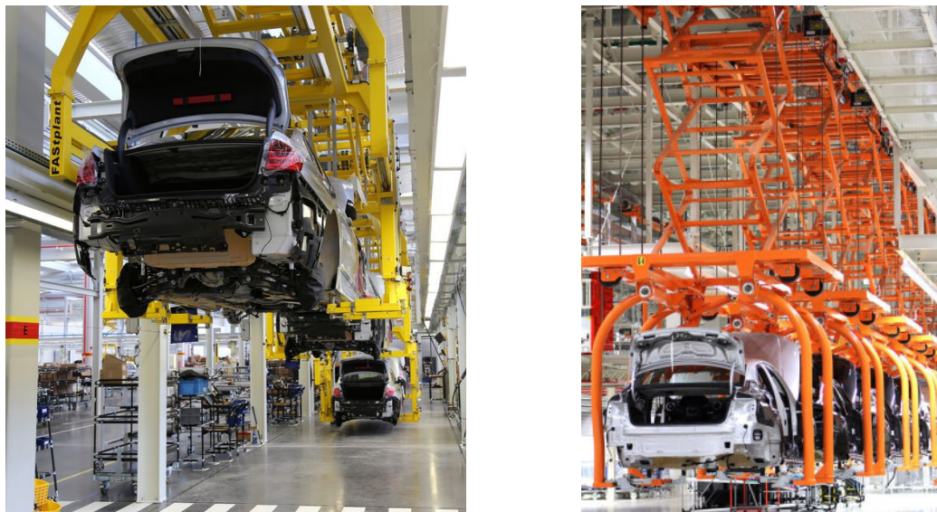
Abbildung 2.7: Gehänge von Elektrohängebahnen mit Hubfunktion.
