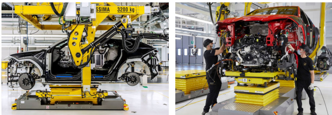
Abbildung 2.14: Interaktion zwischen FTF mit Hubfunktion und Elektrohängebahn zur Werkstückübergabe (links) und der Hochzeit von Fahrwerk und Karosserie (rechts). Quellen: Automobili Lamborghini S.p.A.
