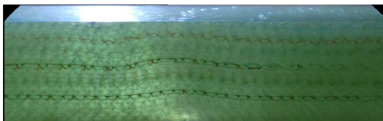
Abbildung 2.4: GFK-Rotorblatt mit sichtbarer Ondulation (Quelle: Holub & Haßler 2012)
