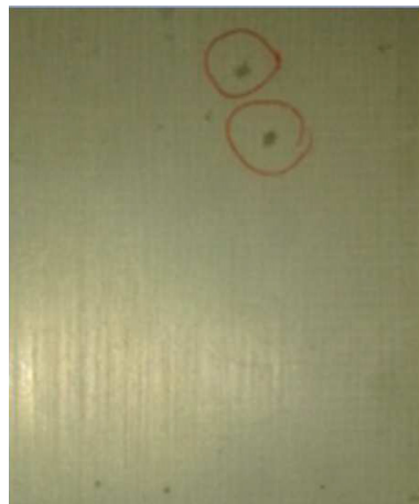
(a) Foto von GFK-Platte mit sichtbaren Einschlüssen
