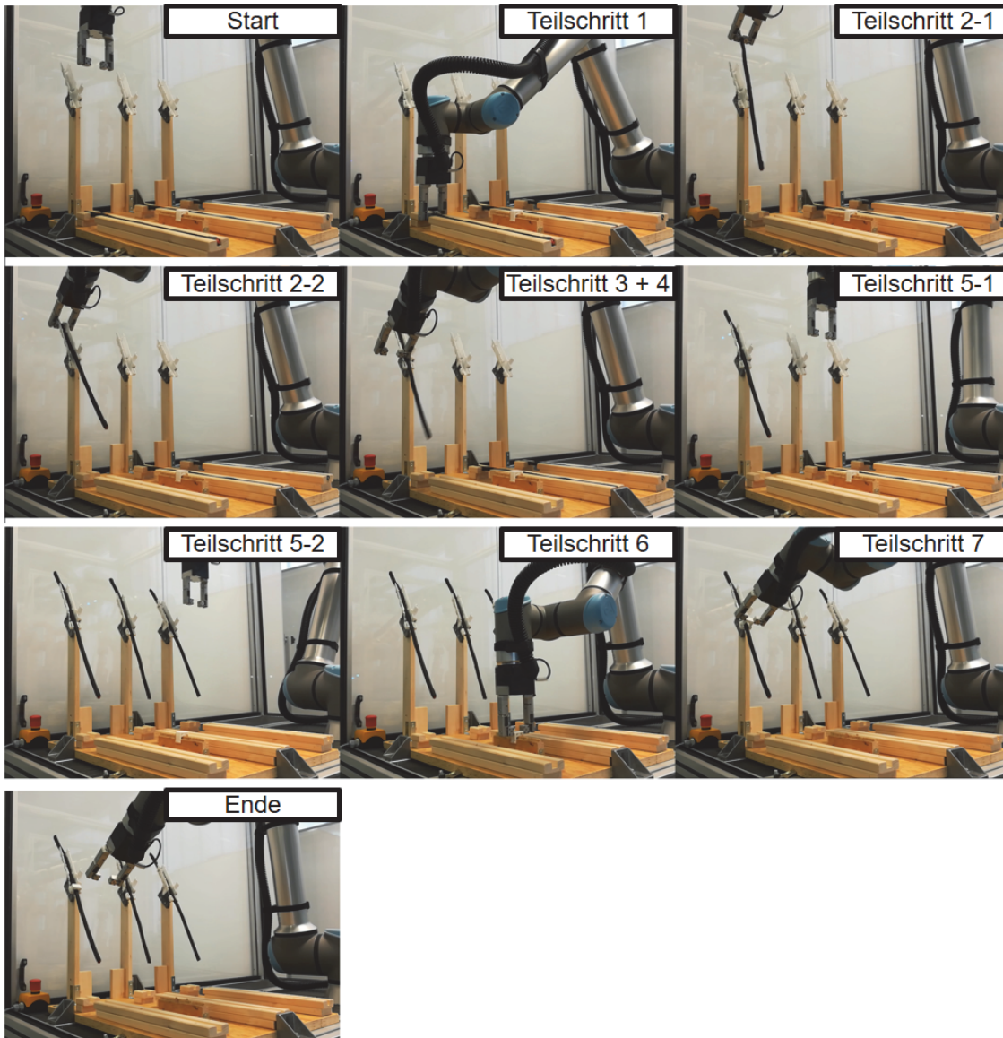
Abbildung 48: Versuchsablauf der automatischen Leitungsbündelmontage in Designvariante 1. Abfolge von links nach rechts je Zeile.
