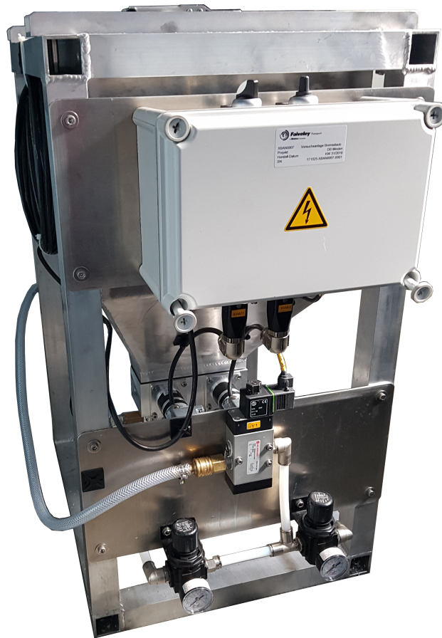
Abbildung 4.13: Staubförderanlage mit Vorrattank und zwei Dosiereinheiten am unteren Auslass
