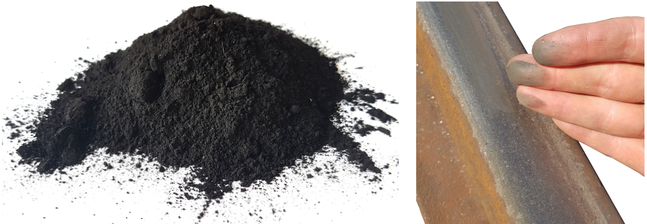
Abbildung 4.14: Das Streugut Bremsstaub links in seiner Reinform, rechts nach dem Ausblasen und Überfahren auf der Schiene (erst durch das Überstreichen der Schiene mit der Hand wird die Schmutzpartikelschicht sichtbar).
