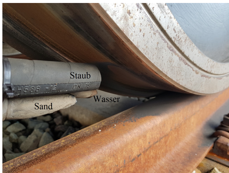
Abbildung 4.12: Anordnung der Wasserdüse und des Staub-Auslassschlauches um das Sandrohr der Testlok
