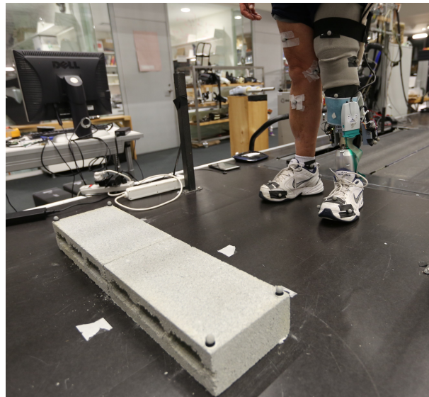
Abbildung B.2: Stufe mit den Abmessungen 20cm x 10cm x 100cm im Bewegungslabor des MIT Media Lab für die Messungen in Unterunterabschnitt 7.6.2
