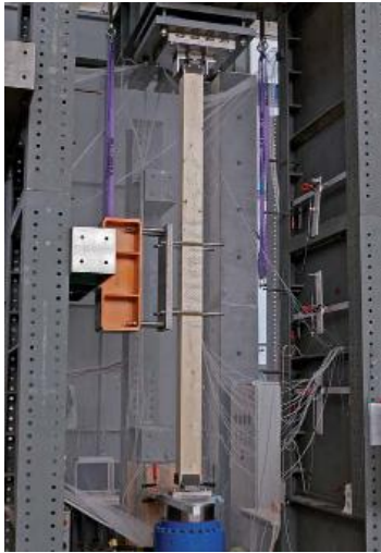
(a) Versuchsaufbau Druckstützenversuche [6]
