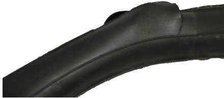
Abbildung A.2: Ausgebauter im Seitenbereich aufgrund von Überdehnung aufgeplatzter Fahrradschlauch (Rueß 2016).
