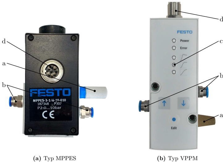
Abbildung 5.1: Pneumatische Proportionalventile, Schalldämpfer a, Steckverschraubung für den Anschluss einer Druckluftleitung b, mittlere Einstellung der Reglercharakteristik c, Anschluss der Steuerungsleitung d.
