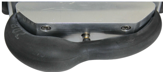
Abbildung A.1: Fahrradschlauch vom Typ SV 15 als Arbeitskammer im Drehantrieb eingespannt. Das unsymmetrische Expansionsverhalten ist deutlich zu sehen (Rueß 2016).
