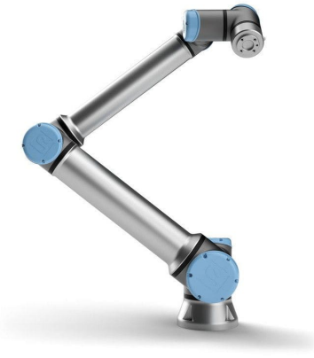
Abbildung 1.1: Kollaborativer 6-Achs-Knickarmroboter vom Typ UR10e des Herstellers Universal Robots (Universal Robots 2020).
