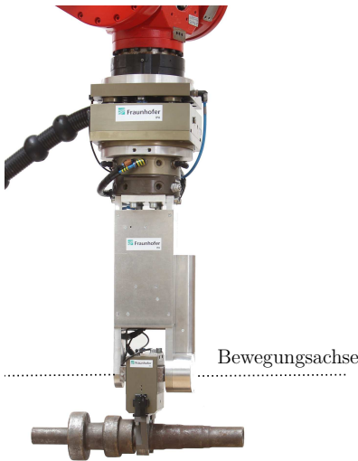
(a) Greifer mit einer Bewegungsachse (Quelle des Originalfotos: Fraunhofer IPA)
