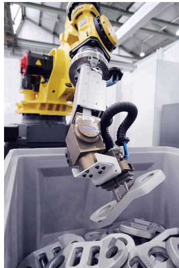
(b) Greifer mit zwei orthogonal zueinander angeordneten Bewegungsachsen (Quelle: Liebherr 2013)
