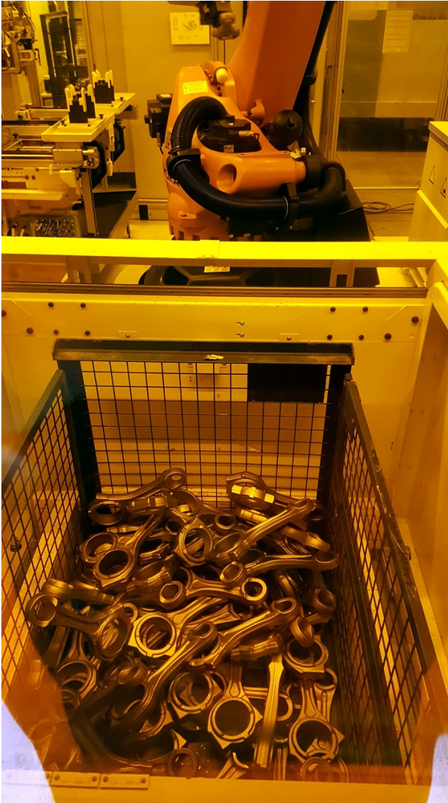
Abbildung 5.5: Gitterbox mit Pleuelstangen in einer industriellen Anlage zur Vereinzelung und Zuführung von Werkstücken bei der MAN Truck & Bus AG
