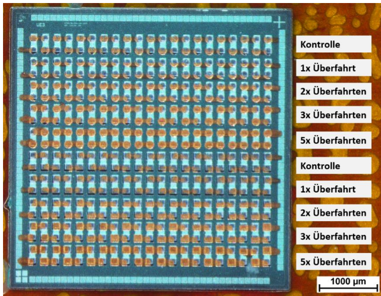
Abbildung 42: Die Anzahl der Überfahrten des Druckkopfes und damit die Anzahl der gedruckten Schichten wurde sowohl für Silber- als auch für Goldtinte variiert. Sowohl in der Hälfte mit runden Kontaktlöchern als auch in der Hälfte mit quadratischen Kontaktlöchern wurden eine Kontrollreihe sowie eine Reihe mit einer Überfahrt, zwei Überfahrten und fünf Überfahrten gedruckt. Die Abbildung zeigt das Druckergebnis der Goldtinte auf einem Substrat mit 130 µm Öffnungsgröße.
