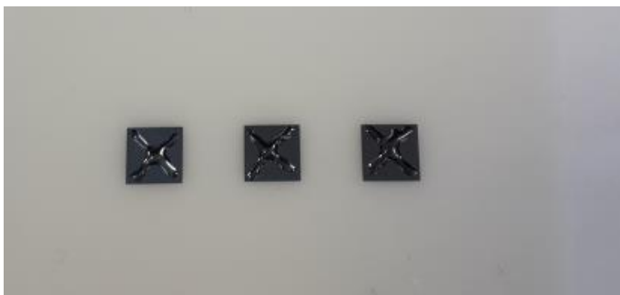
Abbildung 20: Ultradünne Chips fixiert auf einer einseitig klebenden Haftfolie. Es wurde Klebstoff auf die exponierte Rückseite dispent.
