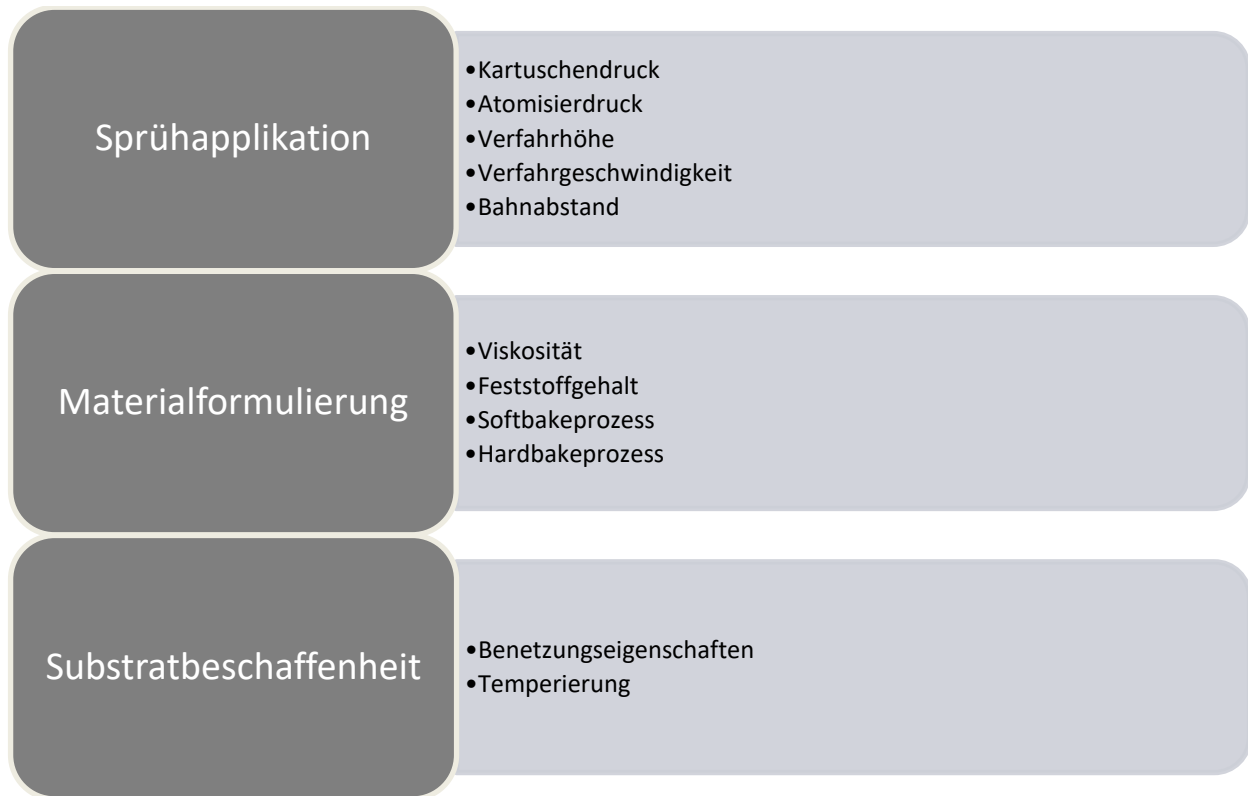
Abbildung 26: Übersicht über die Einflussparameter auf die Schichtqualität nach Sprühbeschichtung eines flüssigen, photosensitiven Mediums.
