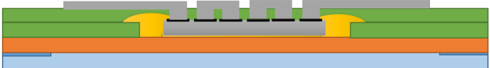
Abbildung 7: Prozessabfolge für die Herstellung eines UTCP unter der Verwendung eines photosensitiven Polyimids. (nach [44])
