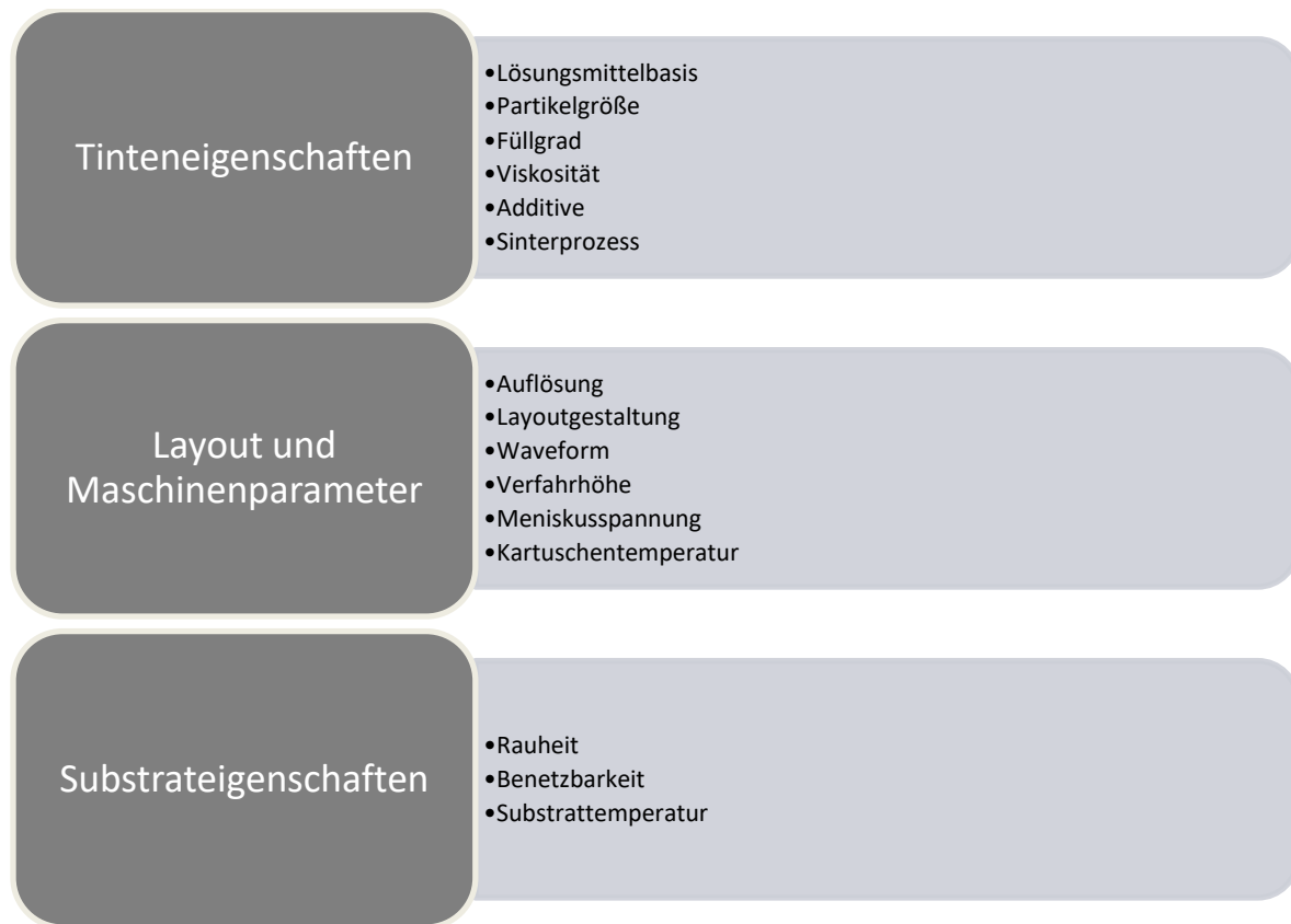
Abbildung 37: Übersicht über Einflussparameter auf das resultierende Druckbild nach dem Inkjetdruck.
