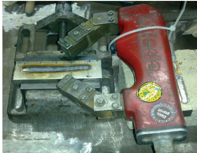
Bild 4.1 Anordnung des Handmagnets um die Einlagenschweißung auf einem Plattenwerkstoff für die Vorversuche.
