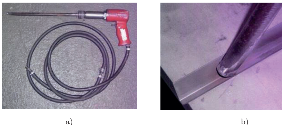
Bild 3.8 Pressluftmeißel zur mechanischen Bearbeitung a) Übersicht, Meißellänge ca. 27 cm; b) Anordnung des Meißels in der Schweißnaht (vorerodierte V-Naht)
