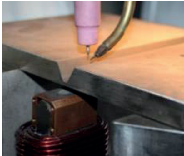
Bild 3.4 Detailaufnahme experimenteller Aufbau mit Elektromagnet, Schweißbrenner, Drahtzufuhr, Nahtgeometrie funkenerosiv hergestellt.
