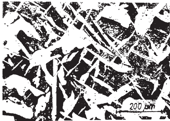
Bild 2.5 Widmannstätten Gefüge, oben: für Stahlguss, entnommen aus [Oet11], unten: für Lichtbogenschweißungen, Vergrößerung 150fach, entnommen aus [Tew48]
