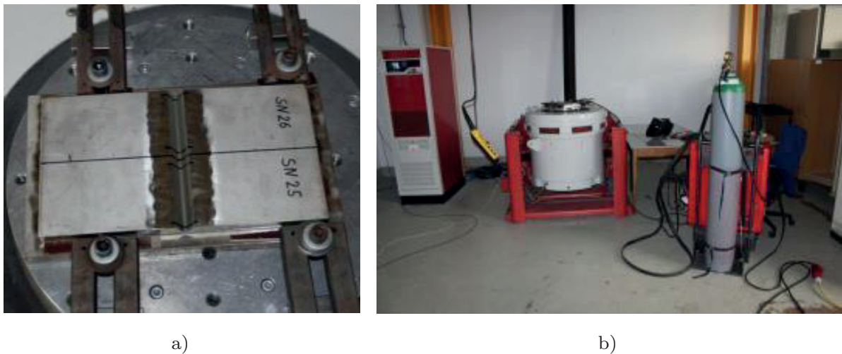
Bild 3.7 Versuchsaufbau Shaker a) Grundwerkstoffplatte mit erodierter Nahtvorbereitung, festgespannt; b) eingerichteter Schweißplatz mit Schutzgasversorgung und (rechts), Rechneinheit zur Ansteuerung des Shakers (links).
