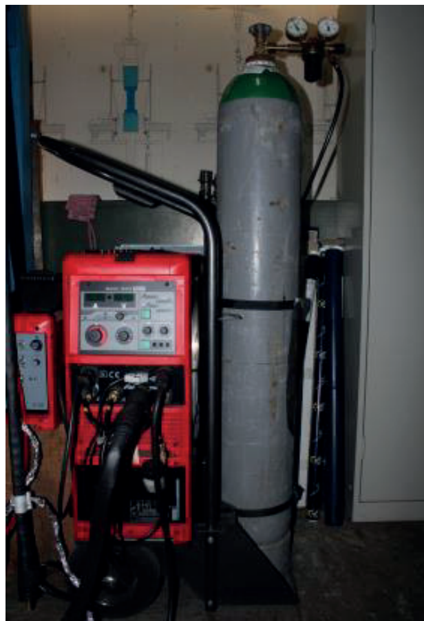
Bild 3.1 Fronius Magic Wave Schweißanlage mit Schutzgasversorgung und den angeschlossenen Brenner- und Versorgungsschläuchen.
