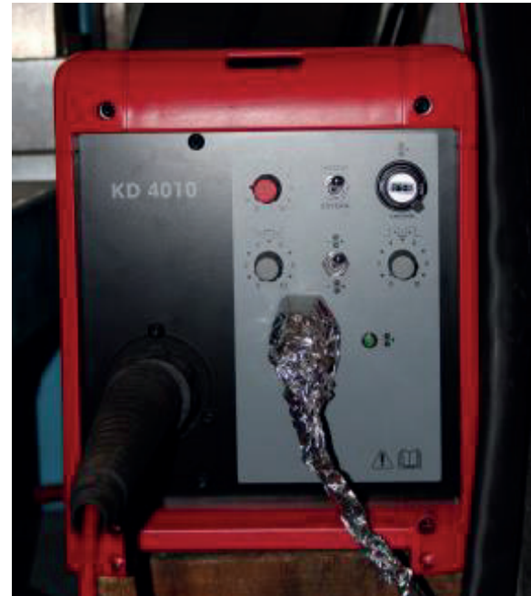
Bild 10.12 Kaltdrahtvorschubgerät KD 4010 der Firma Fronius, Vorschubeinheit mit den Steuerreglern.
