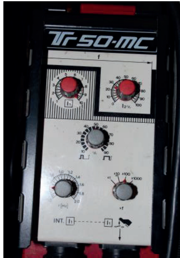
Bild 10.10 Pulsfernregler Fronius TR 50 MC zur Fernsteuerung des Schweißstroms im Pulsbetrieb.
