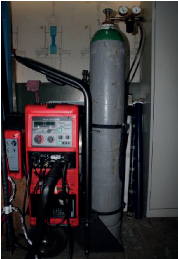
Bild 10.9 Fronius Magic Wave 2600 als Grundlage für den Aufbau einer projektspezifischen Schweißanlage
