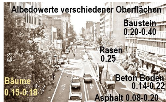
Abbildung 1-7: Dunklere städtische Oberflächen absorbieren während des Tages mehr Wärme und bedingen die städtische Wärmeinsel mit
