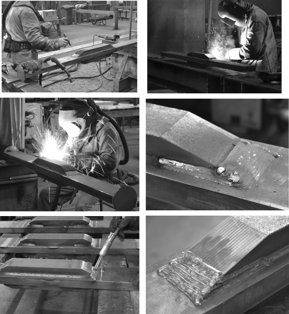
Abb. 6-5: Schweißen der Prüfkörper: Messen von Zwischenlagentemperaturen (o.l.), Schweißen der Flankennaht (o.r.) und (m.r.), Stirnnaht wie geschweißt und ungereinigt (m.r.), Entfernen von Schlackereesten mit Nadelpistole (u.l.), Stirnnaht im Schweißzustand belassen (u.r.)
