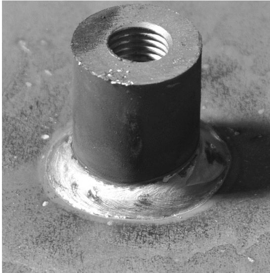
Abb. 6-11: Darstellung der robotergeschweißten Kehlnaht (links) und der Versuchsergebnisse von Serie 15
