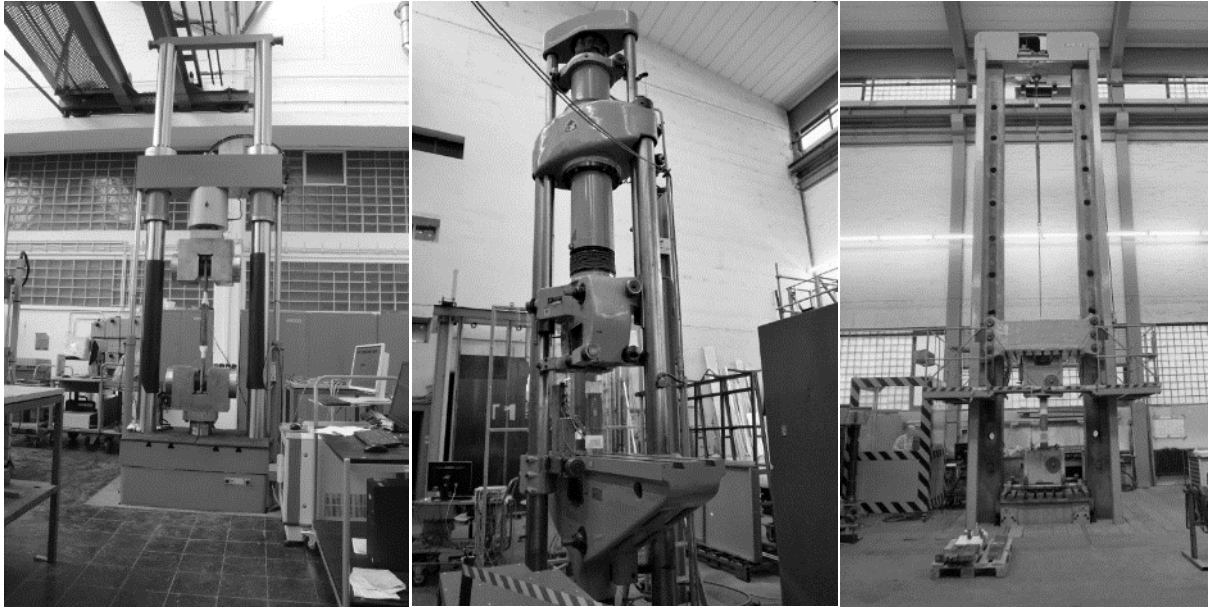
Abb. 6-1: Prüfmaschinen der MPA Stuttgart: 1MN Schenk (links), 1MN Losenhause (mitte), 5MN Amsler (rechts)
