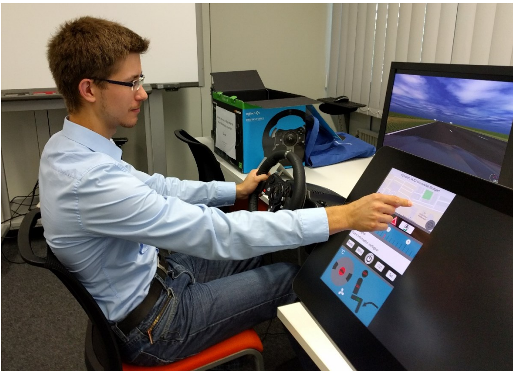
Bild 4.1: Anordnung des Touchscreens im Versuch; eigene Darst.
