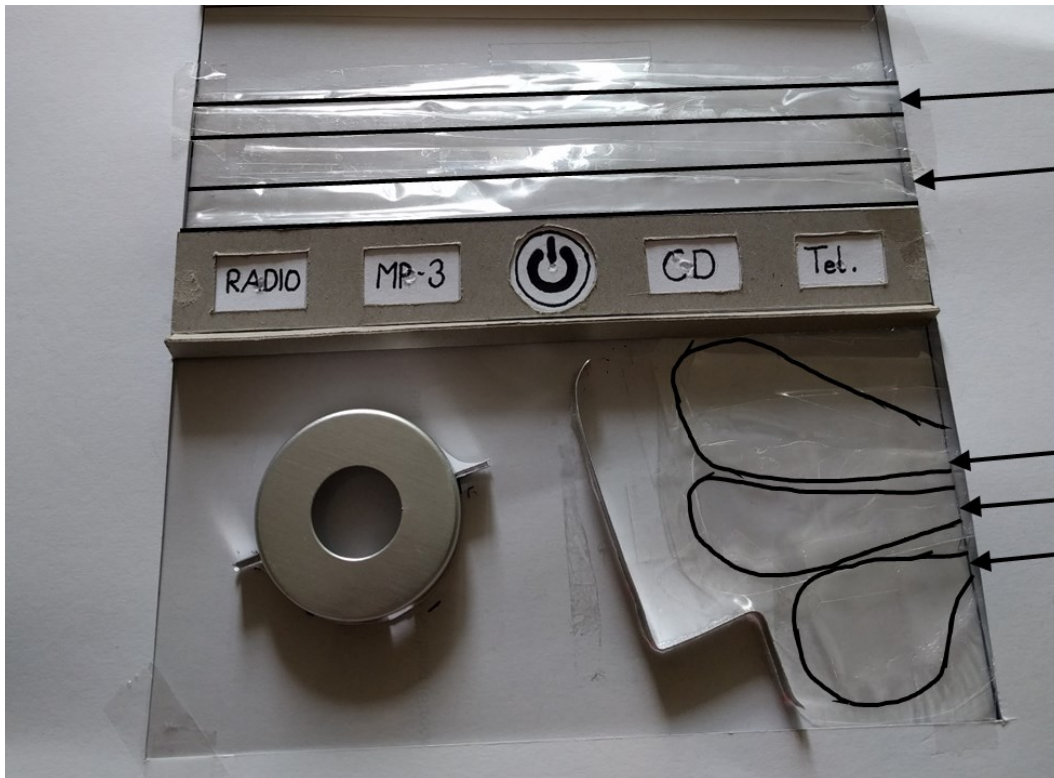
Bild 3.24: Medien- und Klimamodul mit Pneumatik-Elementen; eigene Darstellung
