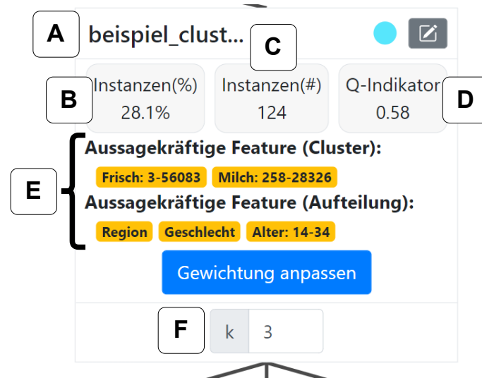
Abbildung 4.5: Aufbau eines Knotens der implementierten hierarchischen Visualisierung mit Knotenname (A), Beschreibung des Knoteninhaltes (B, C, E) und Beschreibung der weiteren Aufteilung des Knotens (D-F)
