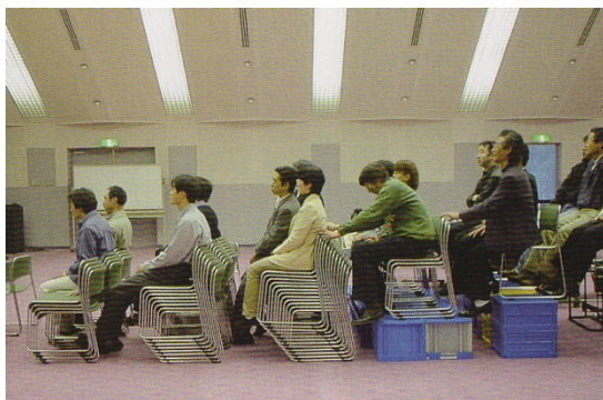
Abb. 5-28 Prüfung der Steigung der Bestuhlung im Maßstab 1:1 (ebd., 84)
