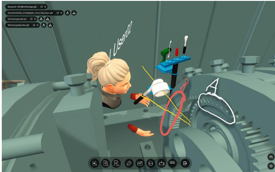
Bild 3: Montageanalyse der Getriebekonstruktion im 3rd Person View mit Menüleiste unten und geladenen Bauteilen links oben; Programm-Screenshot
