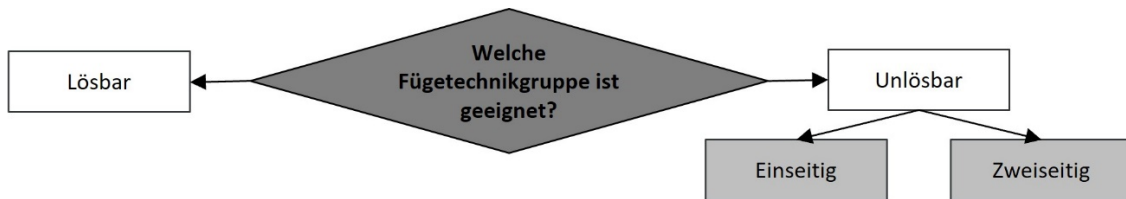
Bild 4: Schematische Darstellung zur Auswahl der Eigenschaften einer Fügeverfahrensgruppe nach dem Ausschlussprinzip
