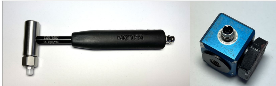
Abbildung 6: Impulshammer der Firma Kistler des Typs 9722A2000 und Beschleunigungssensor der Firma PCB des Typs J356B08
