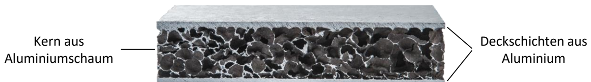
Bild 1: Aufbau eines Aluminiumschaum-Sandwichs
