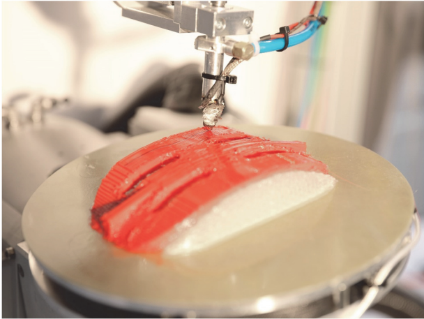
Abbildung 5-4: Mehrachsiger Druck des Orthesenpads (links); Zug-Druck-Kombiprüfmaschine an der Materialprüfanstalt Stuttgart (rechts)
