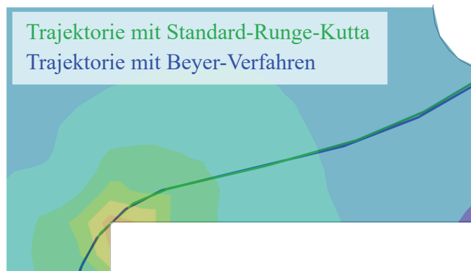
Abbildung 4-7: Hauptspannungstrajektorien mit Runge-Kutta- und Beyer-Verfahren
