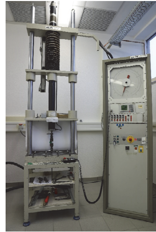
Abbildung 5-4: Mehrachsiger Druck des Orthesenpads (links); Zug-Druck-Kombiprüfmaschine an der Materialprüfanstalt Stuttgart (rechts)
