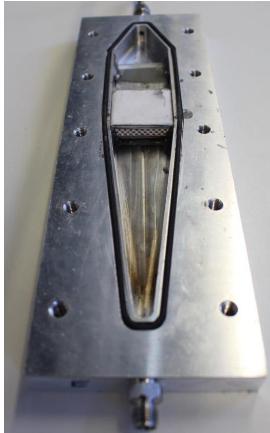
Abb. 3.10: Eingebauter Filter (verstopft und abgedichtet) vor Versuch.
