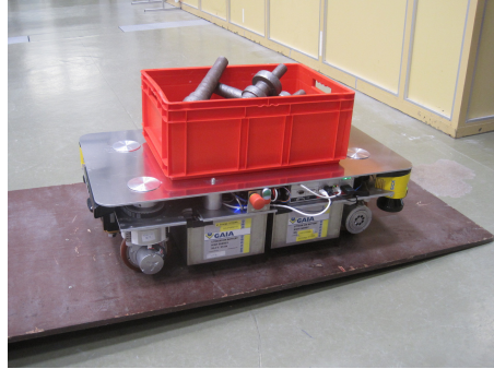
(b) Testplattform mit vier Antriebsmodulen mit Last beim Auffahren auf einer Rampe
