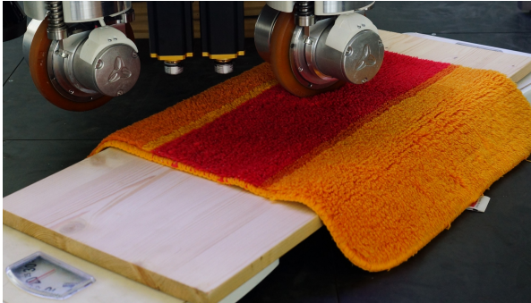
Abbildung 4.5: Versuchsaufbau zur Messung der Reibmomente
