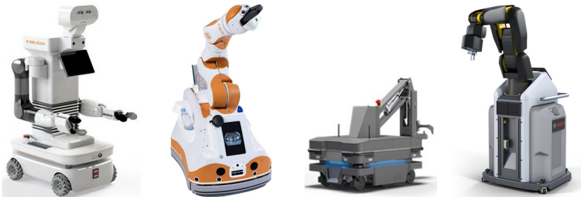
(a) PAL TIAGo mit omnidirektionalem Fahrwerk (PAL Robotics 2021) (b) F&P Lio mit Differentialfahrwerk (Mišekis et al. 2020) (c) MiR Hook 250 mit Differentialfahrwerk (Mobile Industrial Robots 2021) (d) Bosch APAS mit passiven Rollen (Bosch Rexroth 2020)
