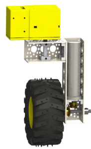
(c) Fahrmotor senkrecht neben dem Rad (Sharifi et al. 2016)
