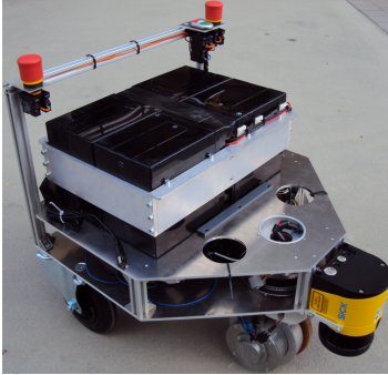
(a) Dreirad-Testplattform mit einem frühen Funktionsmuster des Antriebsmoduls
