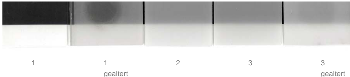
Abb. 57 Transparenzgrad nachkristallisierter Platten (Plattendicke 2 mm)
