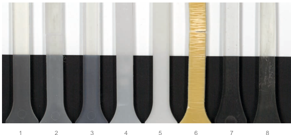
Abb. 65 Probekörper vor und nach Freibewitterung (Probekörperdicke 4 mm)
