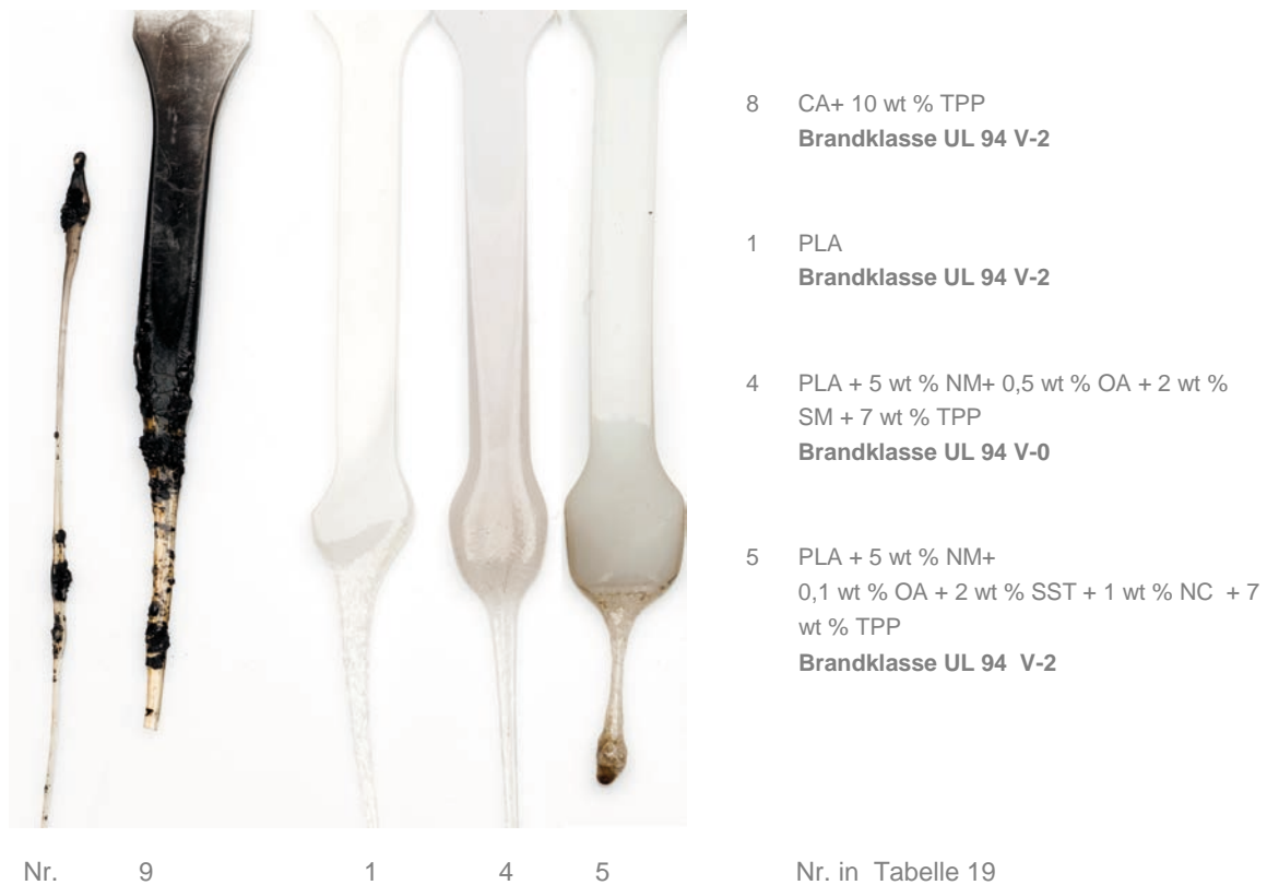
Abb. 52 Probekörper nach den Vertikalbrennprüfungen nach UL 94 (Dicke der Probekörper 4 mm)
