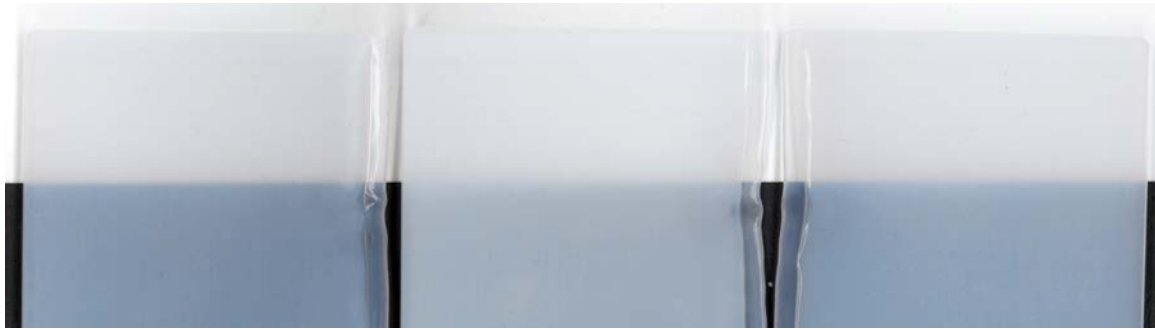
Abb. 60 Verzug beim Tempern ohne Tempervorrichtung (120-240 Minuten bei 75-100 °C getempert) Plat- tendicke 2 mm
