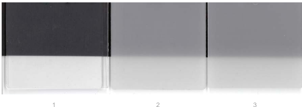
Abb. 56 Geringere Lichtdurchlässigkeit der Proben mit verbesserter Wärmeformbeständigkeit (Plattendicke 2 mm)
