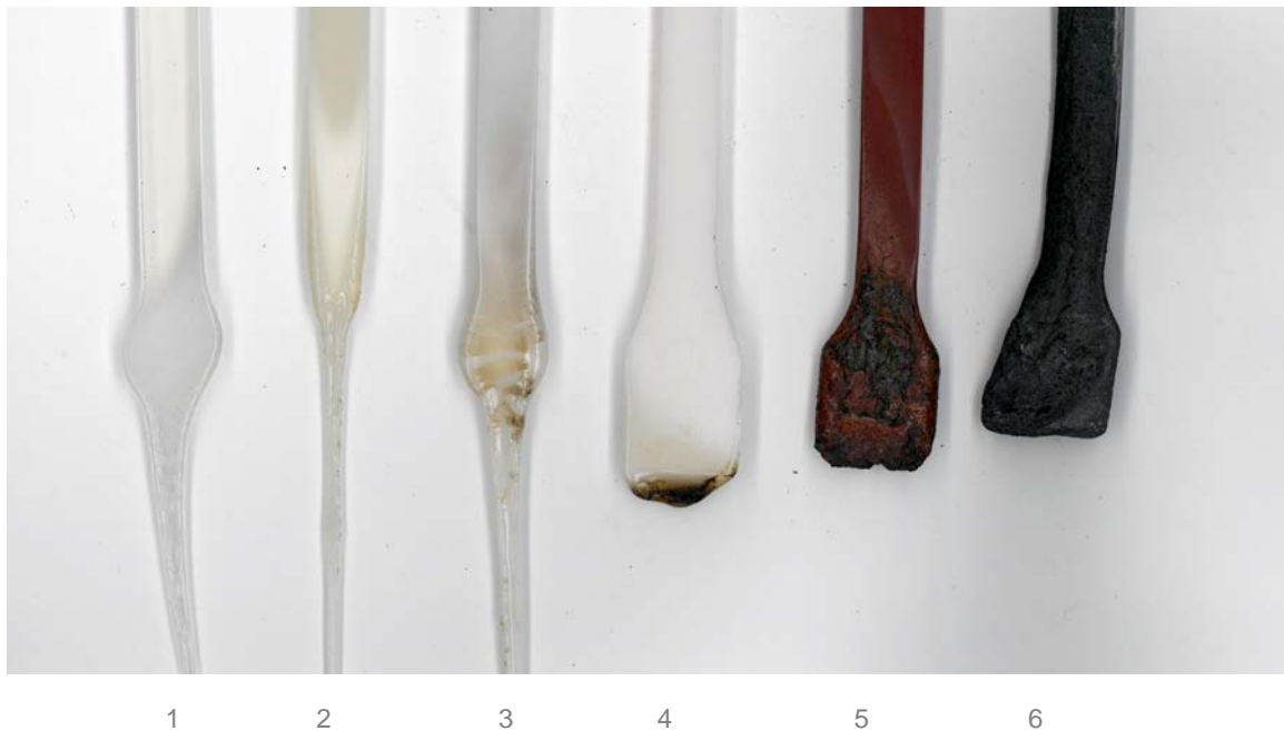
Abb. 96 Prüfstäbe nach den Brandprüfungen nach UL94-V (Probekörperdicke 4 mm)
