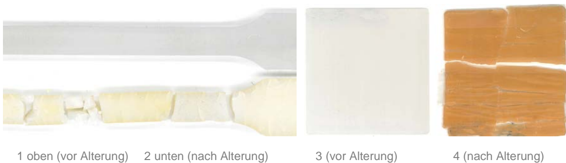
Abb. 63 PLA-TPP-Compound nach 1024 Stunden Globalstrahlung hinter Fensterglas - Probekörperdicke 4 mm (1+2) und 2 mm (3+4)
