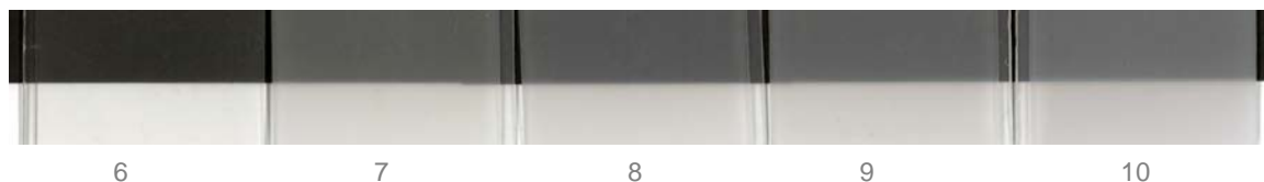
Abb. 51 Auswirkung von Nukleierungsmittel und Schlagzähigkeitsmodifizierer auf die Transparenz (Plattendicke 2 mm)
