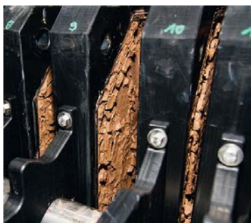
Abb. 7 Organosolv-Lignin nach Fällung und Filtration auf der Filterpresse © Fraunhofer CBP [27]
