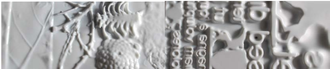
Abb. 128 Tiefgezogene Oberflächenstrukturen auf Biokunststoffplatte [381]
