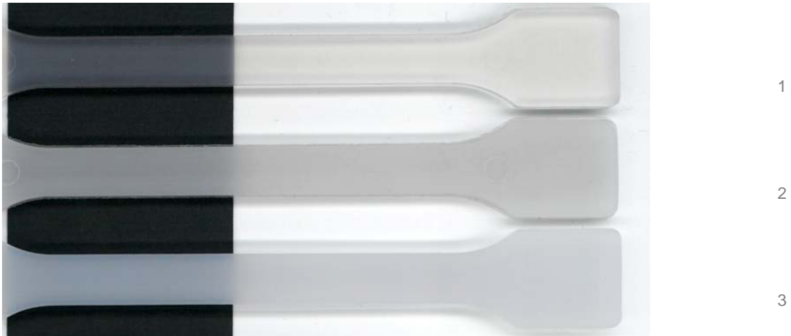
Abb. 61 Transparenz im Vergleich: Längere Kühlzeit oder nachträgliches Tempern (Probekörperdicke 4 mm)
