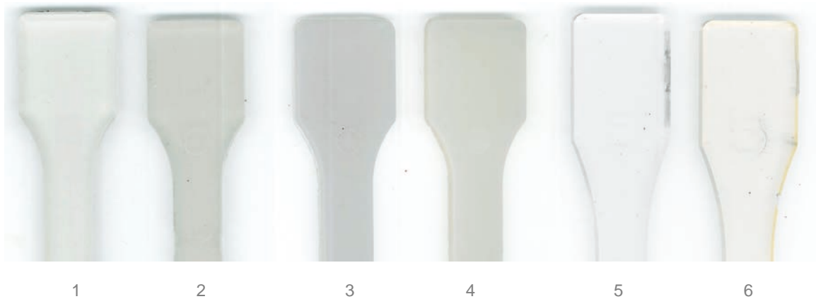
Abb. 62 Probekörper vor und nach 341 Stunden Globalstrahlung hinter Fensterglas
