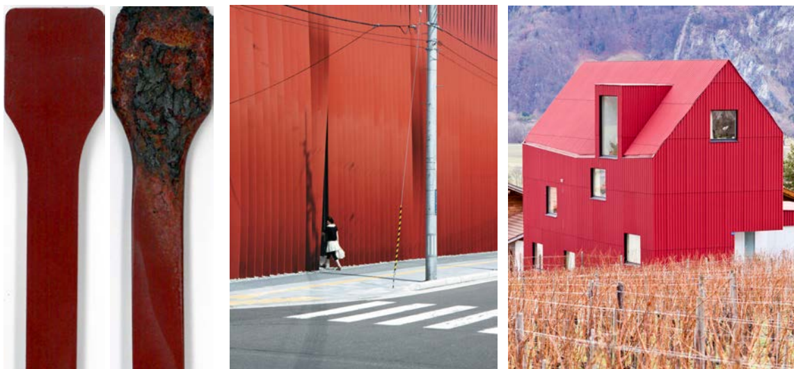
Abb. 90 Ergebnis der Compoundierungsversuche aus Polylactid mit rotem Phosphor vor und nach Brandversuchen
