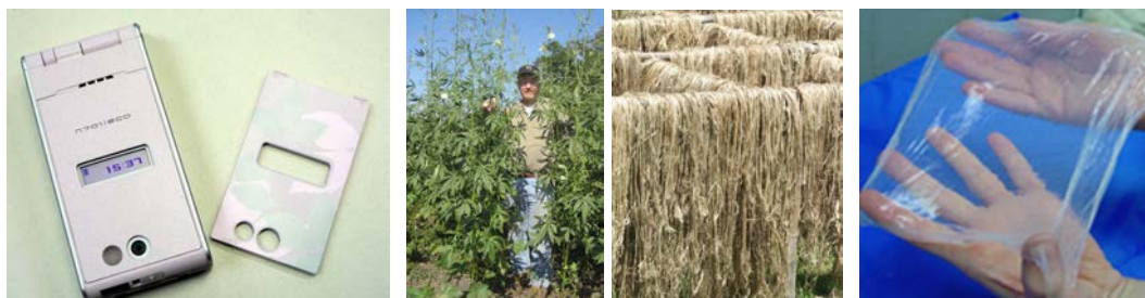
Abb. 101 Handygehäuse aus einem PLA-Kenaf-Verbund, N701i ECO © NEC [352]
