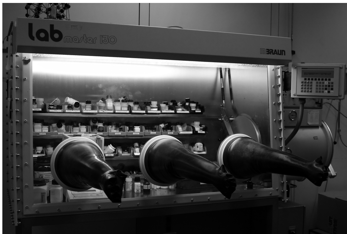
Abb. 2.3: Argon-Glove-Box Labmaster 130 (Fa. M. Braun).
