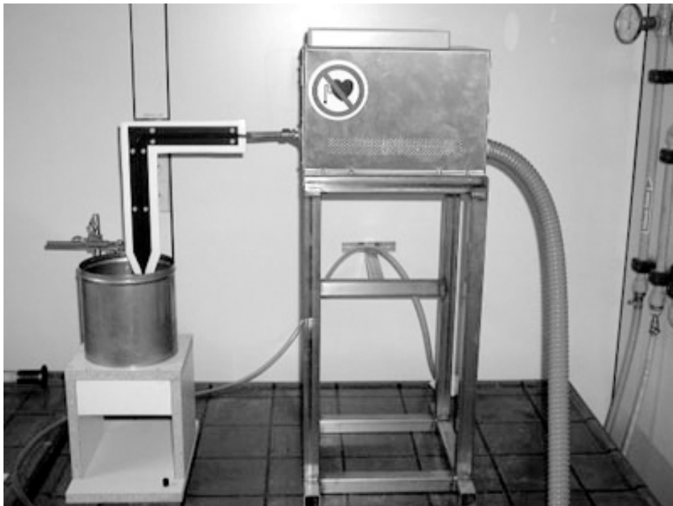
Abb. 2.4: Hochfrequenz-Induktionsofen (Fa. Linn High Therm).
