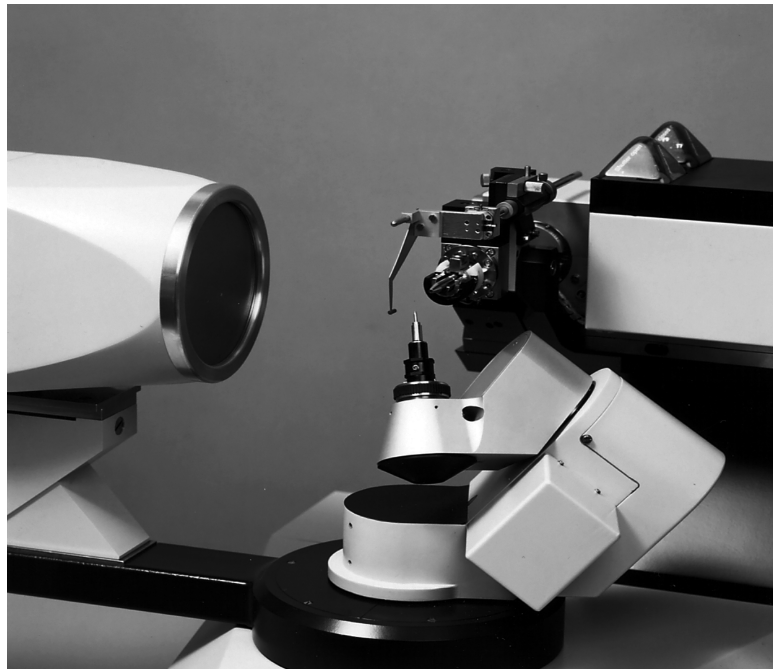
Abb. 2.12: \kappa -CCD-Einkristalldiffraktometer (Fa. Bruker-Nonius): Links ist der CCD-Detektor, in der Mitte der Goniometerkopf und dahinter der Strahlenfänger zu erkennen.
