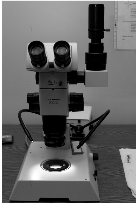
Abb. 2.7: Stereomikroskop SZX9 (Fa. Olympus) mit zusätzlicher Schwanenhalslampe als Auflichteinheit.
