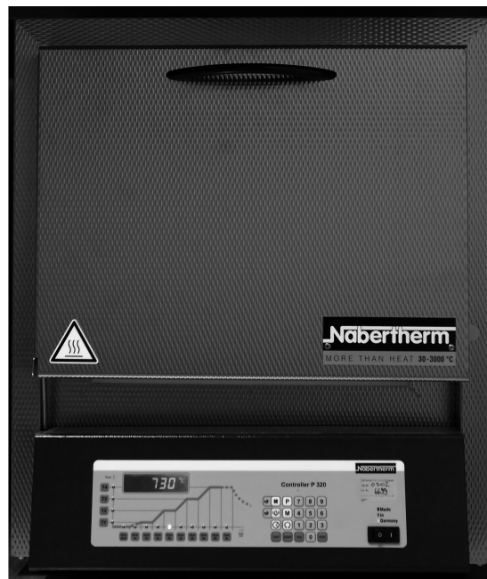
Abb. 2.6: Muffelofen mit Steuerungseinheit für den Temperaturverlauf (Fa. Nabertherm).
